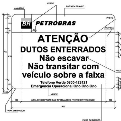
Figura VII.4.1.3-1 - Modelo Padrão de Placa de Sinalização Tipo I (Características Gráficas). Extraído de norma interna da Petrobras.
