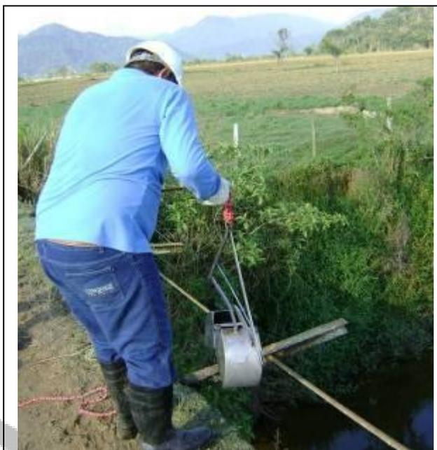
**Foto V.2.3.3-8** – Amostragem de sedimento com auxílio do pegador do tipo Van Veen.
