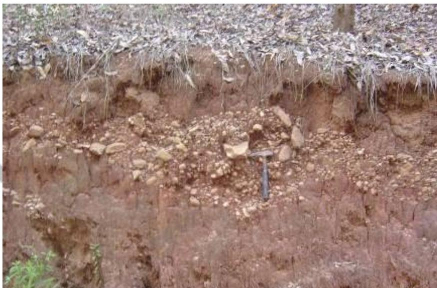
**Foto V.2.8.3-3** – Vista de um corte de encosta de morro com exposição dos solos coluvionares areno-silto-argilosos com *stone line* na base. Região do município de Paraibuna. Coordenadas UTM: 7.411.973/ 427.636. Fonte: Mineral, 2011.
