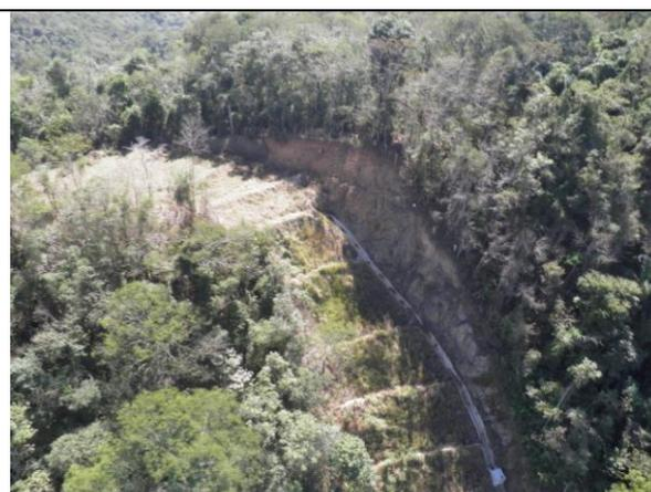
**Foto V.2.8.6-12** – Vista da faixa GASTAU, onde serão implantados os dutos OCVAP I e II. Detalhe para talude sem proteção com sistema de canaleta junto à faixa. Foto tirada durante sobrevôo no dia 16/08/2011. Coordenadas UTM: 7.425.368 / 421.846. Município de Jambeiro.
