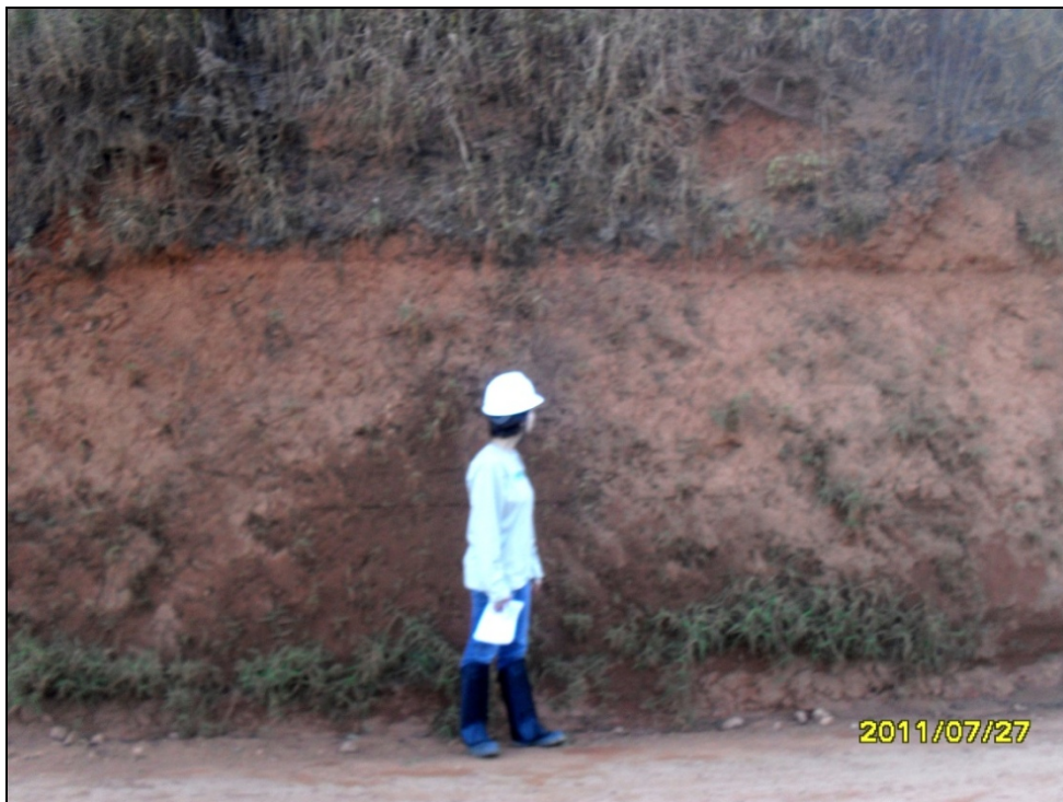
Foto 3 - Corte de estrada expondo latossolo no município de Itaverava, próximo à localidade de Pé do Morro, onde se observa cobertura pedológica bem desenvolvida.
