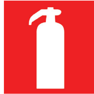
Figura 55 – Sinalização de extintores
