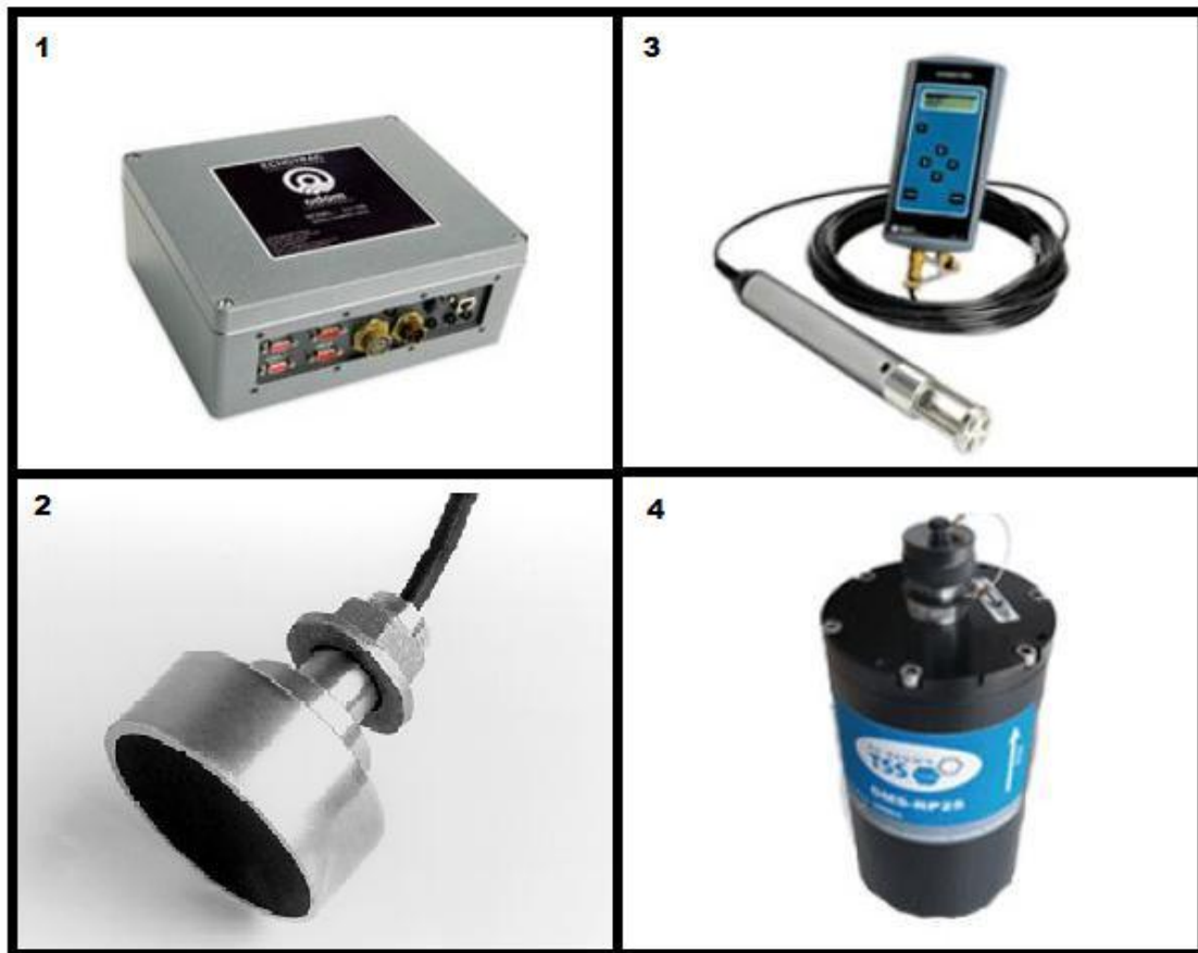
Figura 1. Ecobatímetro (1), sonda batimétrica Odom modelo SMBB200-9 (2), medidor de velocidade de som Digibar-Pro (3), compensador de movimentos (4), equipamentos utilizados nos levantamentos de perfis na Praia de Jaconé, Maricá - RJ.
