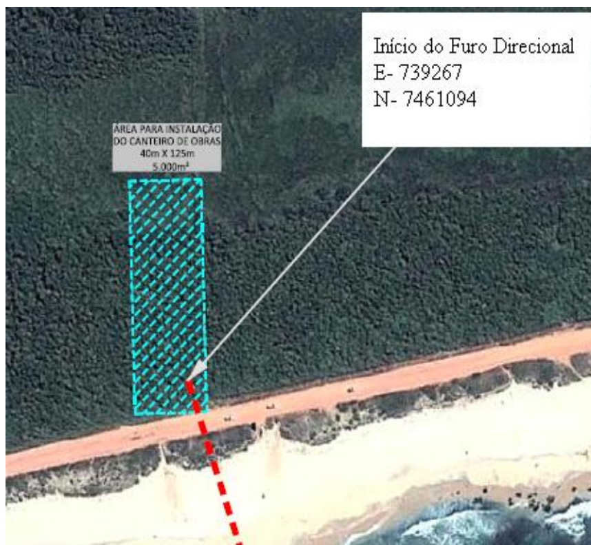
Figura 3.4-31 - Local de instalação do canteiro de obras para o furo direcional. Fonte: Petrobras.
