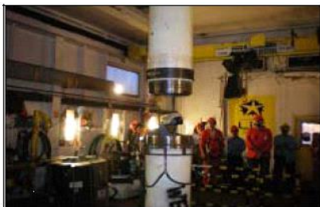
Figura 3.4-24 - Alinhamento e enquadramento dos Quad Joints. Fonte: Petrobras.
