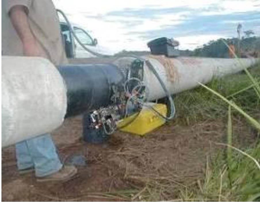
Figura 3.4-52 - Ultrassom END - típico. Fonte: Petrobras.
