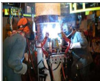
Figura 3.4-25 - Soldagem dos Quad Joints. Fonte: Petrobras.
