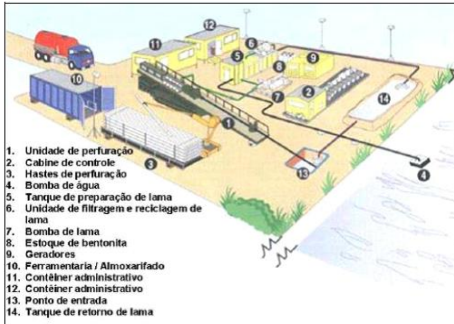
Figura 3.4-32 - Desenho esquemático de canteiro típico de uma localização, com seus equipamentos. Fonte: Petrobras.
