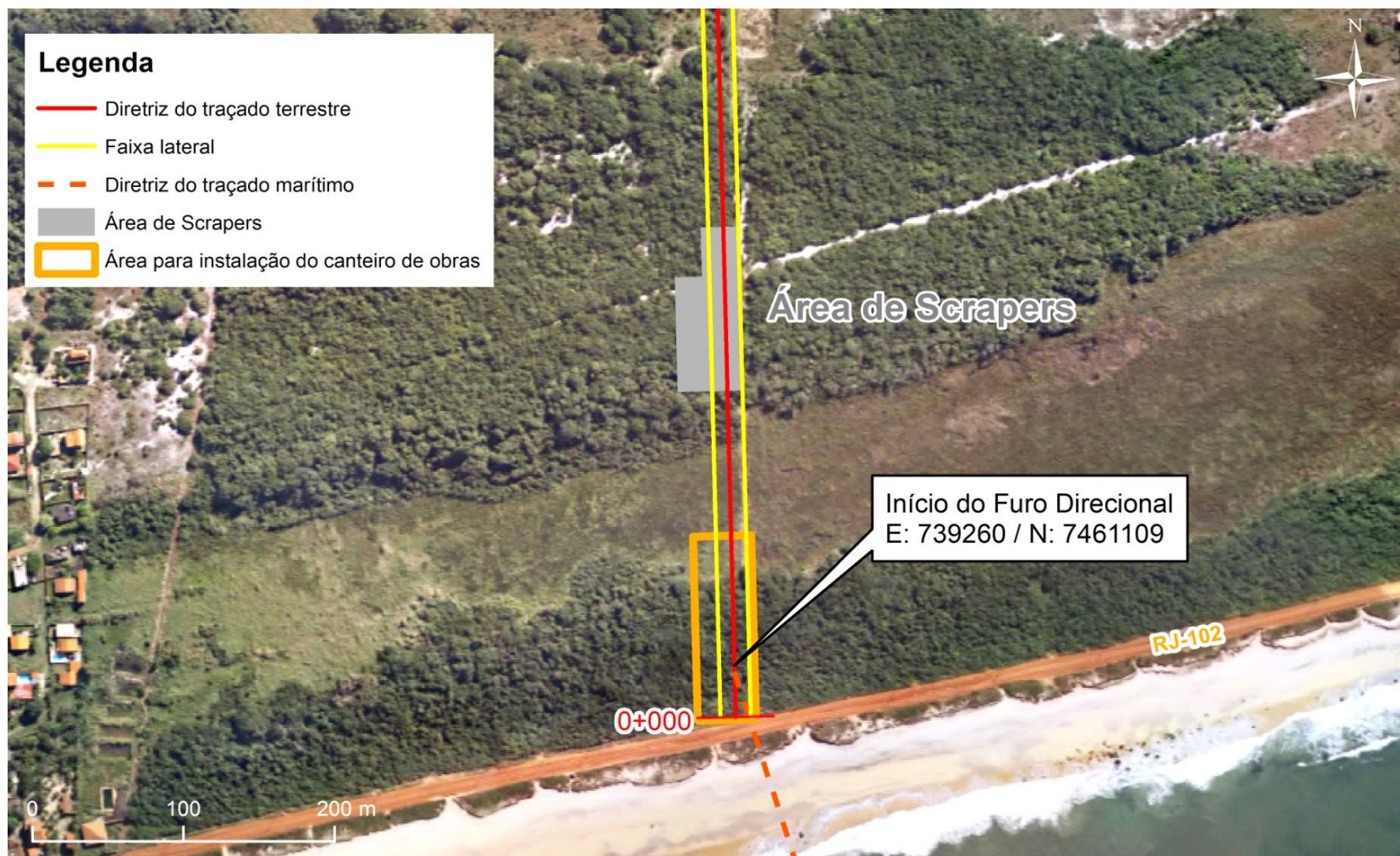
Figura 3.4-2 - Localização do ponto de chegada na praia de Jaconé (Maricá), onde será realizado furo direcional e da Área de Scrapper.
