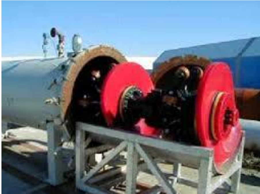
Figura 3.4-8 - Pig - típica. Fonte: Petrobras.
