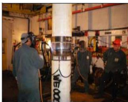
Figura 3.4-25 - Soldagem dos Quad Joints. Fonte: Petrobras.
