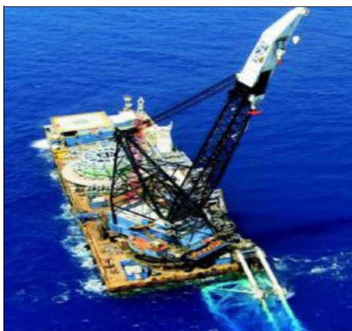
Figura 3.4-18 - Embarcação típica de lançamento S-lay, tipo Balsa. Fonte: Petrobras.
