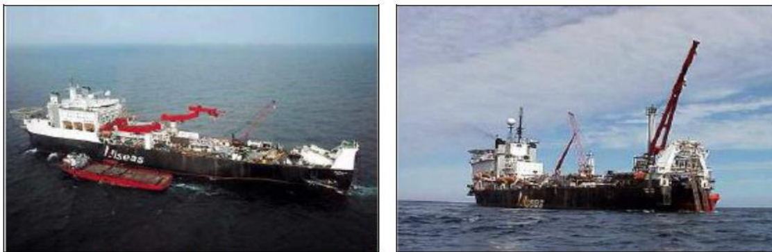
Figura 3.4-17 - Embarcação típica de lançamento S-lay, tipo Navio. Fonte: Petrobras.
