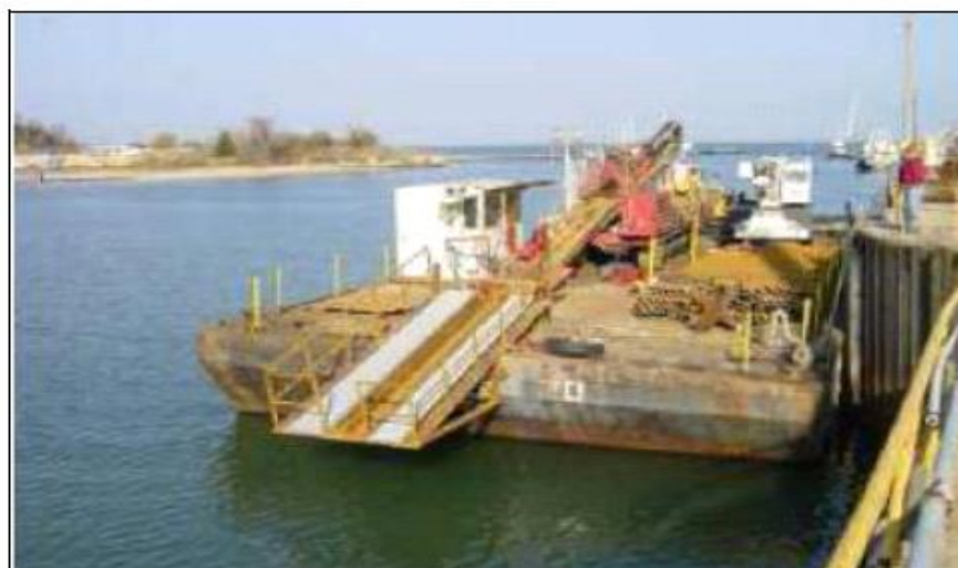
Figura 3.4-37 - Sonda de perfuração montada na balsa de suporte marítimo. Fonte: Petrobras.
