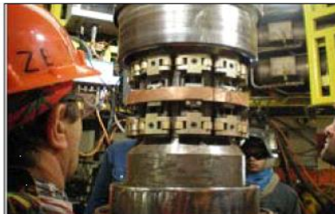
Figura 3.4-24 - Alinhamento e enquadramento dos Quad Joints. Fonte: Petrobras.
