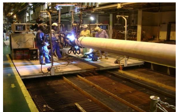
Figura 3.4-12 - Preparação dos tubos para soldagem. Fonte: Petrobras.
