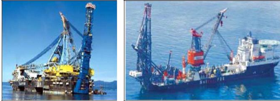
Figura 3.4-28 - Embarcações típicas de lançamento J-lay: semissubmersível e navio. Fonte: Petrobras.
