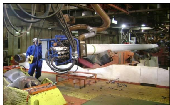
Figura 3.4-12 - Preparação dos tubos para soldagem. Fonte: Petrobras.
