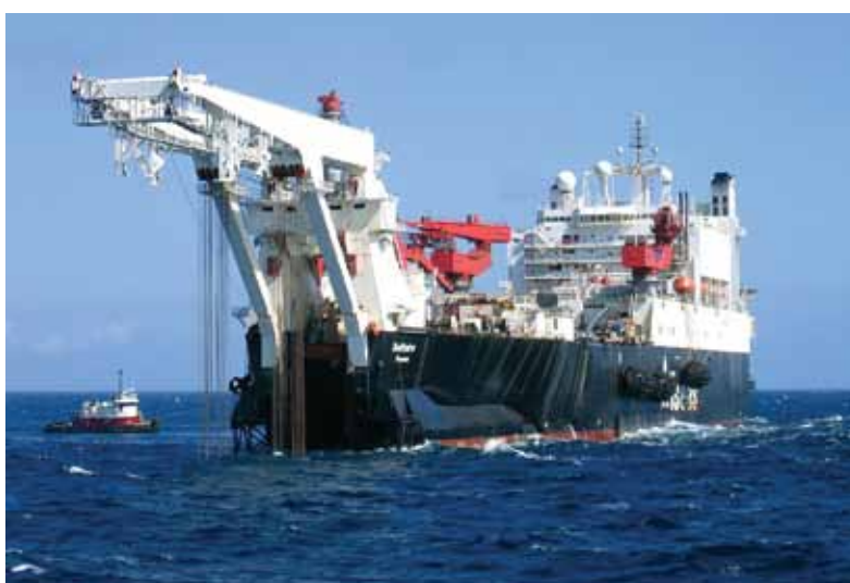
Embarcação de lançamento de dutos em águas profundas.
