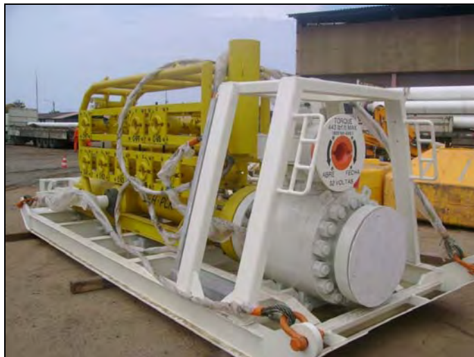
Figura II.2.4.1.1.8-2 - Exemplo de skid valve 12 pol com lançador de pig.
