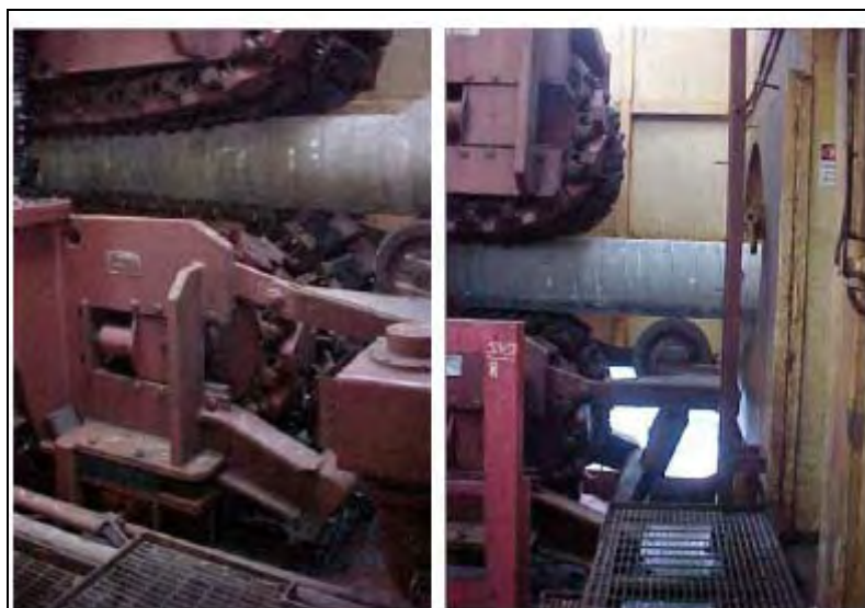
Figura II.2.4.2.1-2 – Tracionador de uma embarcação Típica S-Lay.
