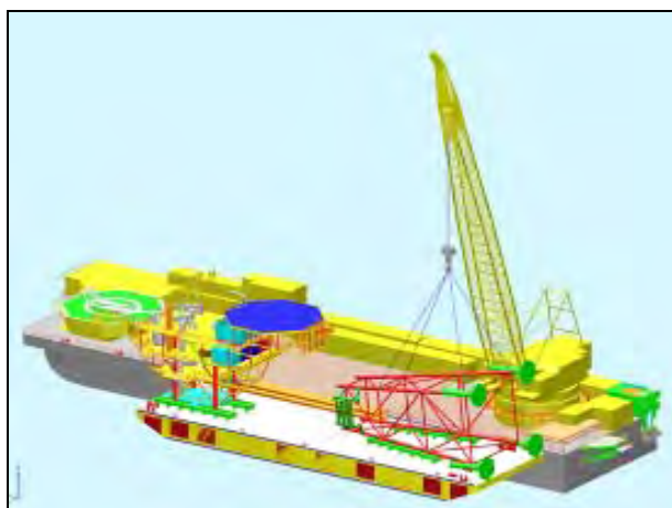
Figura II.2.4.1.1.4-2 – Atracação balsa na BGL-1 e içamento da jaqueta
