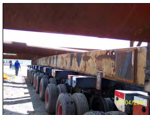
Figura II.2.4.1.1.2-2 – Assentamento das Estruturas no veículo
