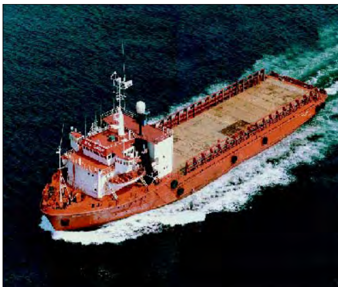
Figura II.2.4.5.2-1 - Exemplo de Embarcação Utilizada para Transporte de Tubos (Piper Carrier).
