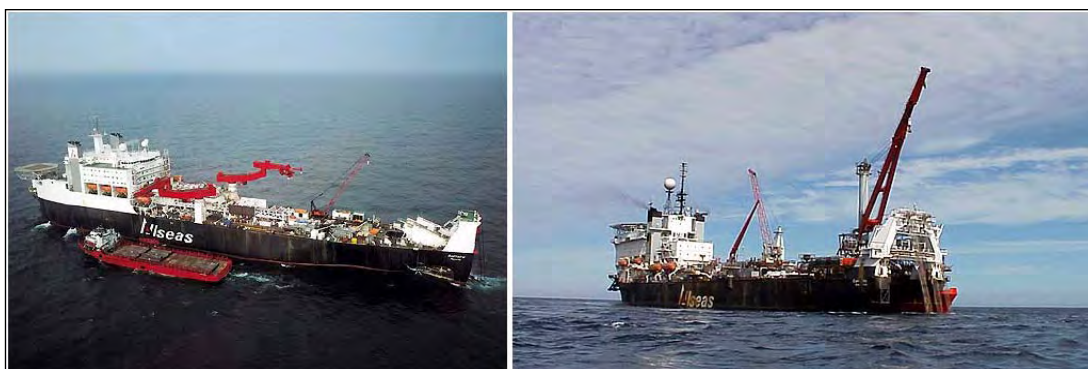
Figura II.2.4.2.1-6 – Embarcação Típica de utilização do método S-Lay do tipo Navio.
