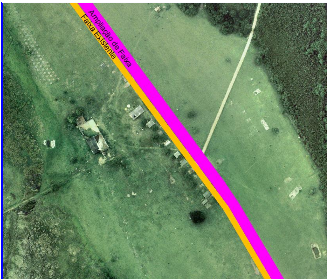
Figura 44 - Ampliação da faixa para a direita da existente de modo a evitar atingir a população
