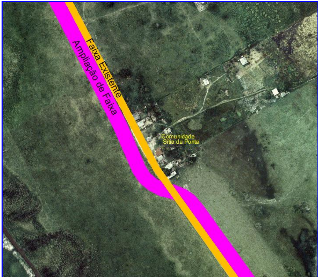
Figura 45. Ampliação da faixa a esquerda do duto existente
