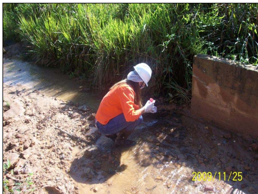
FOTO 6.1.3-21: Coleta à jusante do Córrego do Acácio, no km 201+300m do empreendimento, 02 dias após concluídas as obras de travessia, coordenadas em UTM: N=7.637.896/E=647.304 (Fonte: REMMA Egesa, nov/09).
