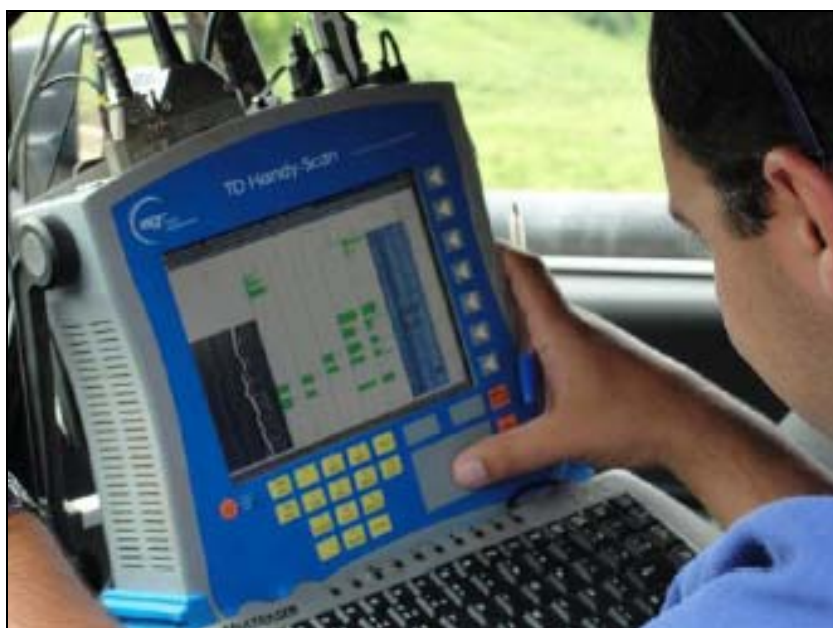
FOTO 6.1.2-47: Aparelho para fazer a leitura da junta soldada, km 64+780, coordenadas em UTM N=7.530.369/ E=649.635 (Fonte: Remma Azevedo & Travassos, mar/10).
