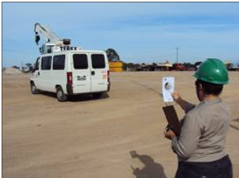
FOTO 2.6.14-50: Medição de fumaça no canteiro de obras (Fonte: Remma GDK, fev/10).
