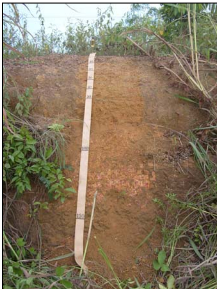
Foto 3 - Detalhe de corte de estrada representando perfil de Latossolo Amarelo Distrófico petroplíntico textura argilosa relevo suave ondulado. Coordenadas 5,0036S 49,0769W
