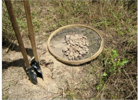
**Figuras 5 e 6:** À esquerda, aspecto atual da área cercada destinada à expansão do Ponto de Entrega Araçás. À direita, escavação de poço-teste e solo característico em local de alta compactação dos sedimentos.
