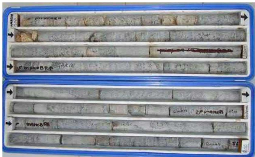
**Figura 03 – Caixa de testemunhos com rocha granítica
