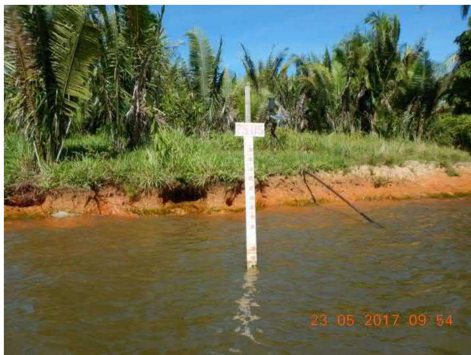
**Figura 2-11: Leitura de réguas para monitoramento do nível d'água durante a aquisição de dados.**
