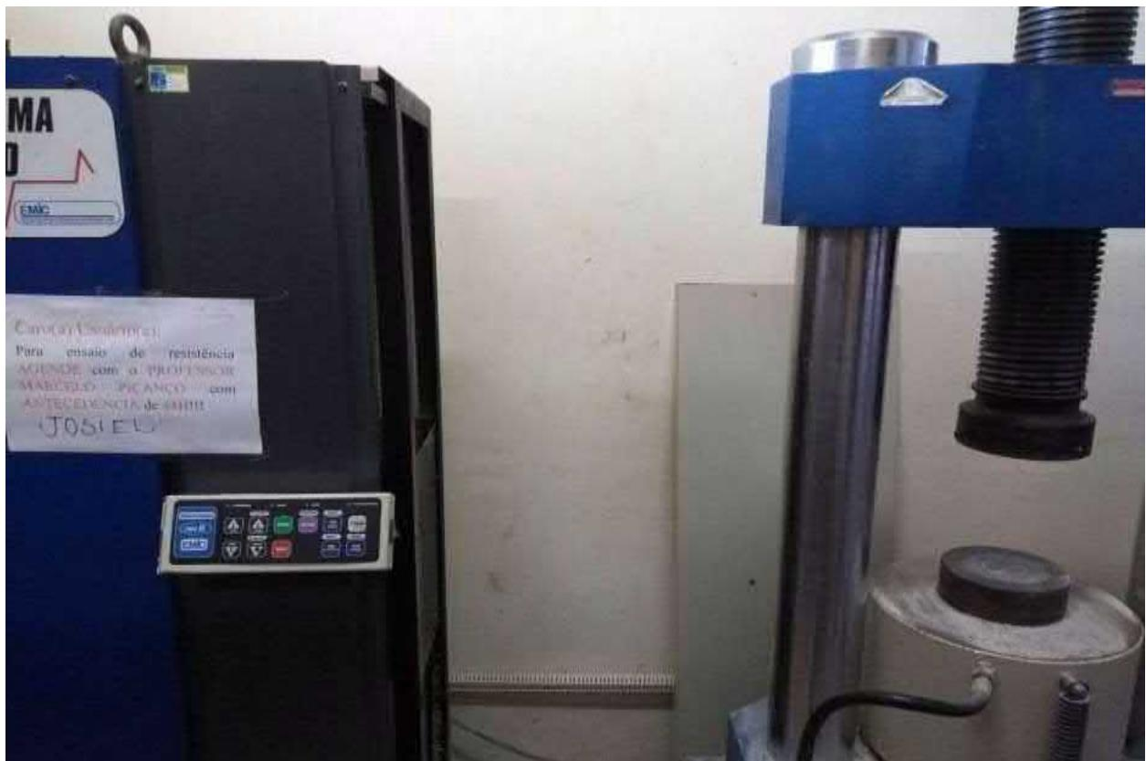
**Foto 22** - Prensa hidráulica, realização de ensaio de compressão simples
