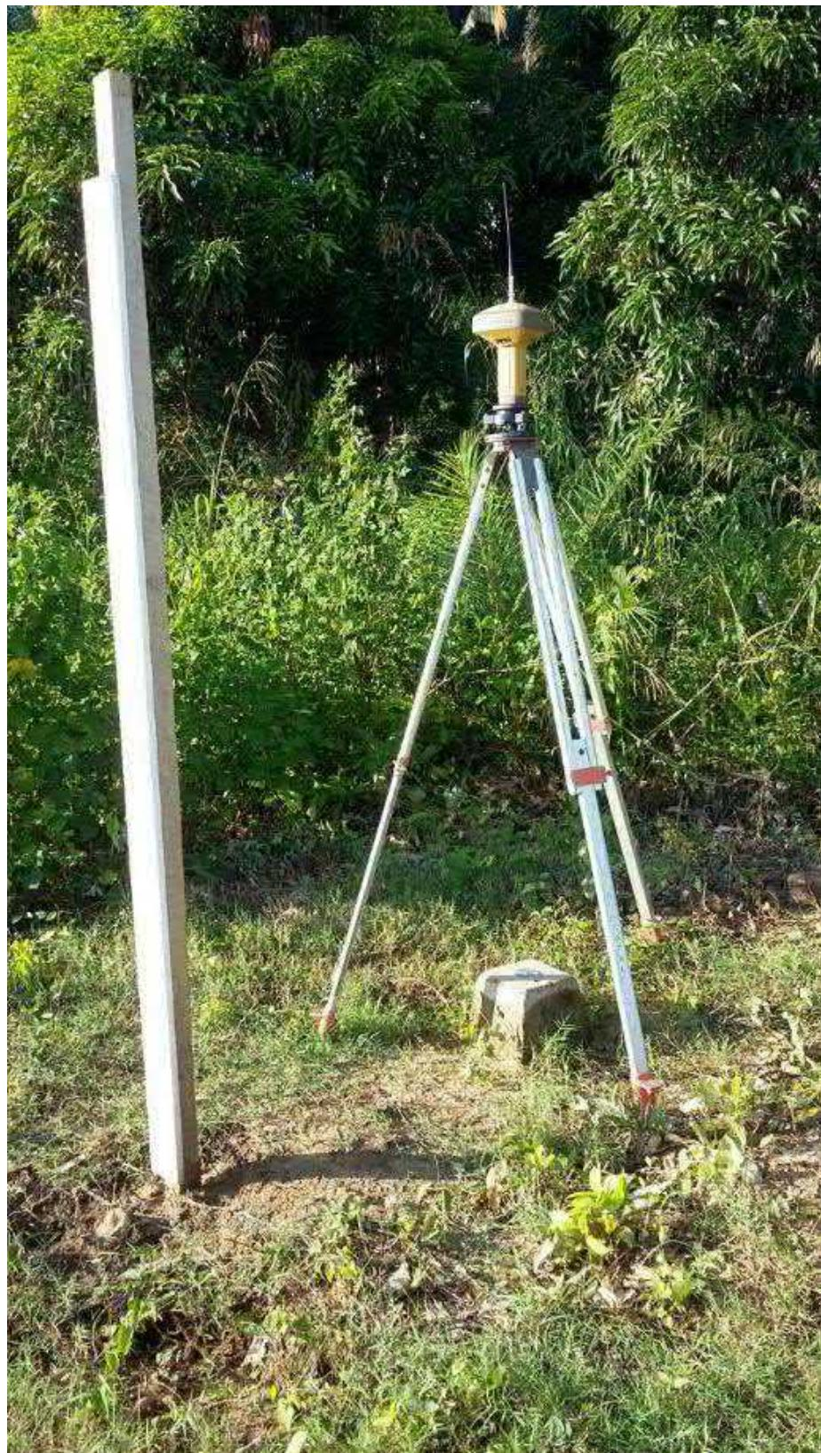
**Figura 20: Base RTK sobre Referência de Nível.**
