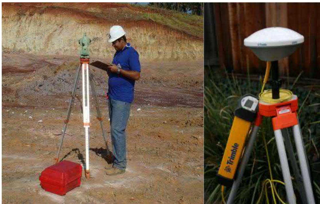
Figura 7 – À esquerda, estação total; à direita, equipamento RTK (foto ilustrativa)
