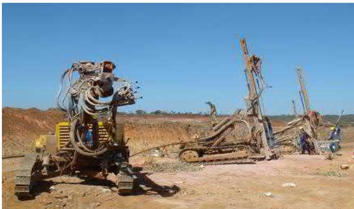
Figura 9 – Conjunto de perfuratrizes pneumáticas (foto ilustrativa).
