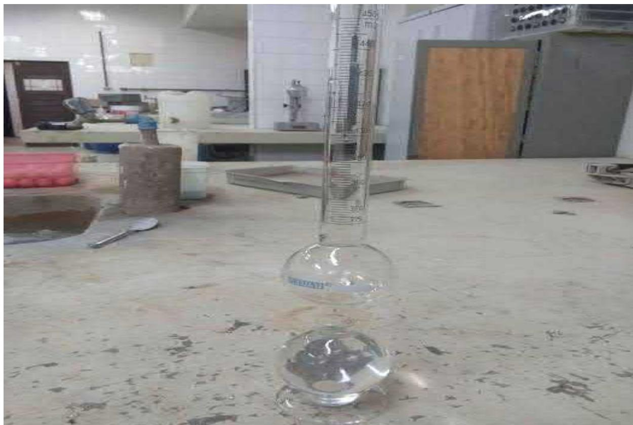
**Foto 23** - Bancada do laboratório do GAEMA (10/10/17) - Ensaio de massa específica
