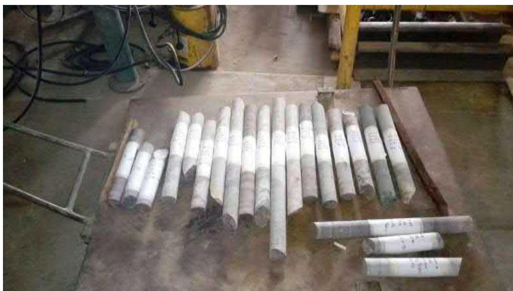
**Foto 21** - Testemunhos separados para a preparação dos corpos de prova
