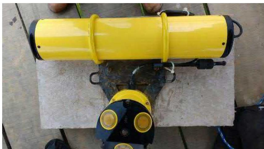
**Figura 2-16:** ADP preso à estrutura de poita utilizada no fundeio.
