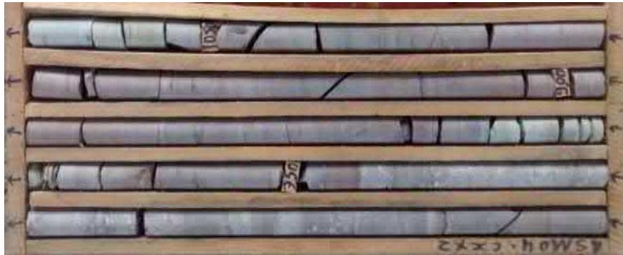
**Figura 04 – Caixa de testemunhos com rocha granítica e basalto
