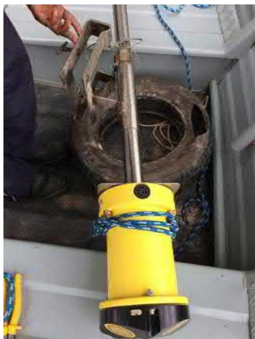
**Figura 2-17: ADP fixado à estrutura de aço inox para medição de vazão na lateral da embarcação.**
