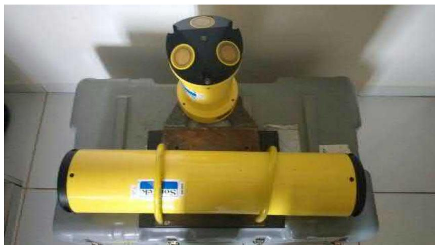
**Figura 2-15:** ADP e bateria da marca Sontek/YSI de 1000 kHz utilizado no fundeio.
