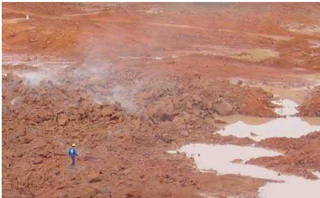
Figura 12 - Verificação do material detonado
