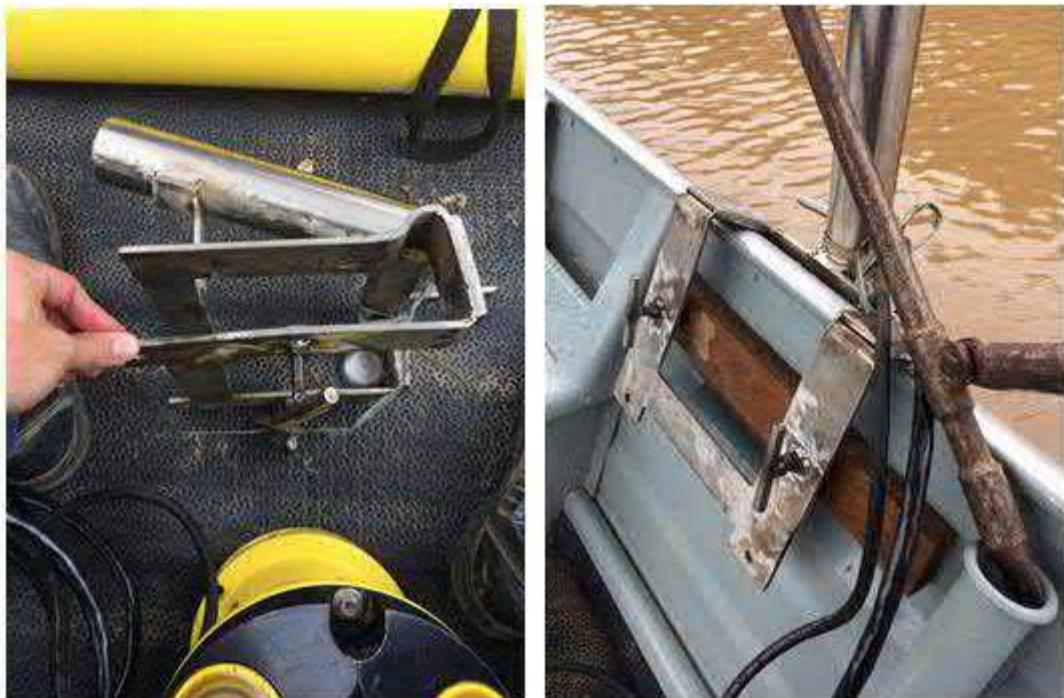
**Figura 2-18: Estruturas de aço utilizadas para a fixação do ADP.**
