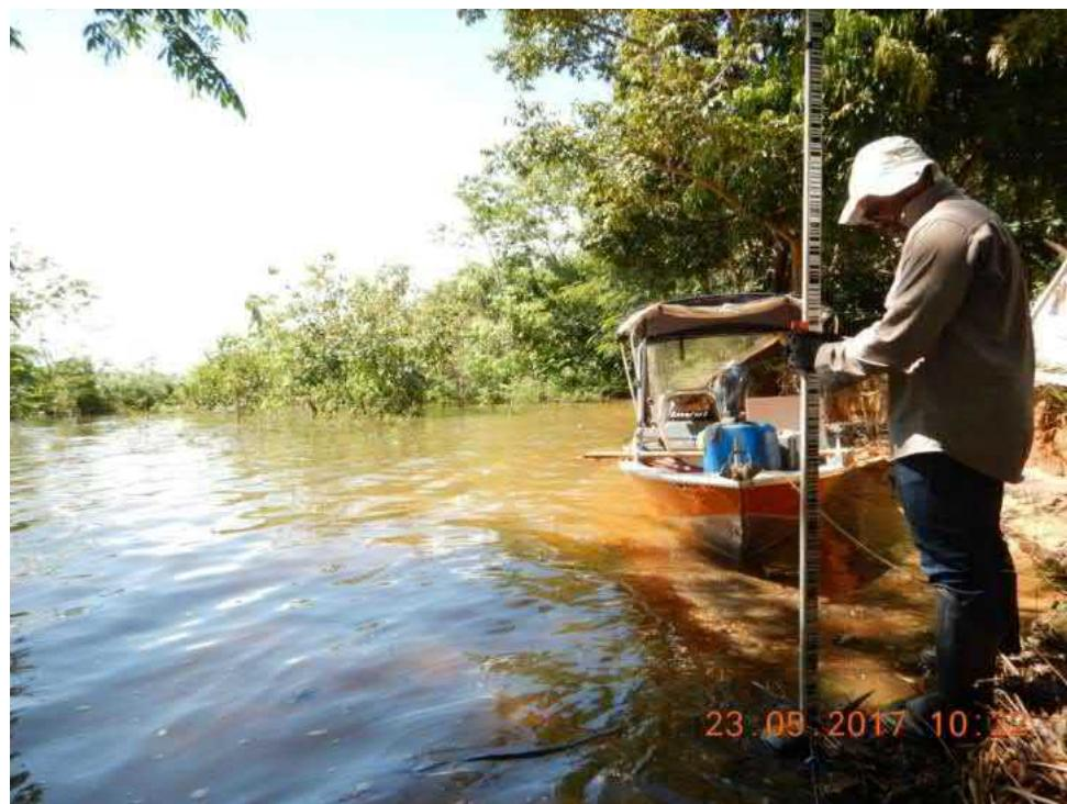
**Figura 2-12: Obtenção da lâmina d'água por nivelamento geométrico na seção MDL-11.**
