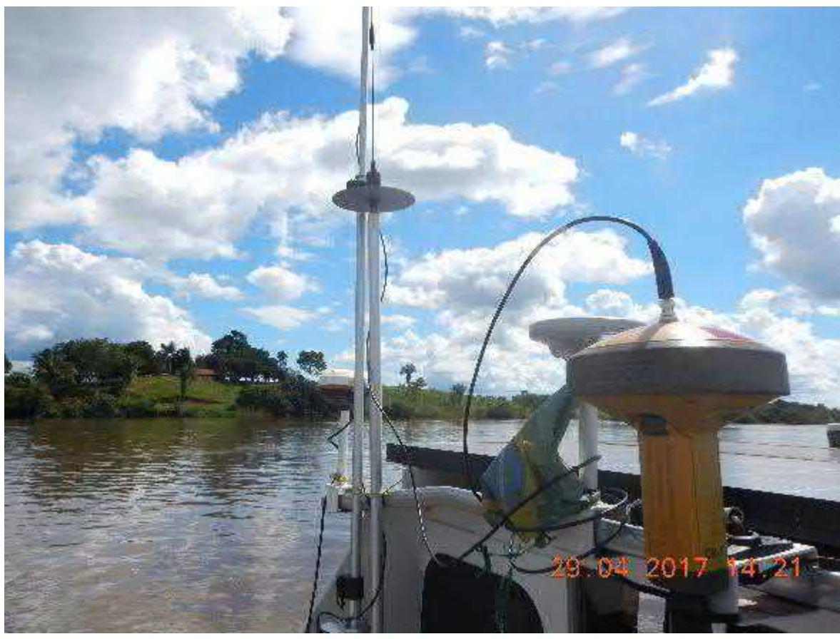
Figura 22: Receptor RTK e rádio.
