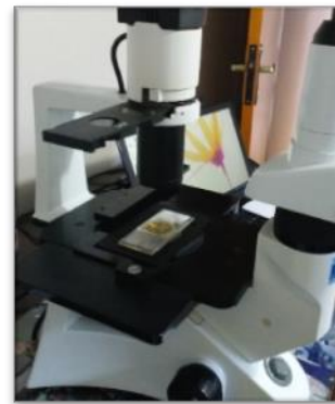
Foto 5.2.1-150 - Quantificação do fitoplâncton realizada pelo método de sedimentação em câmaras.
