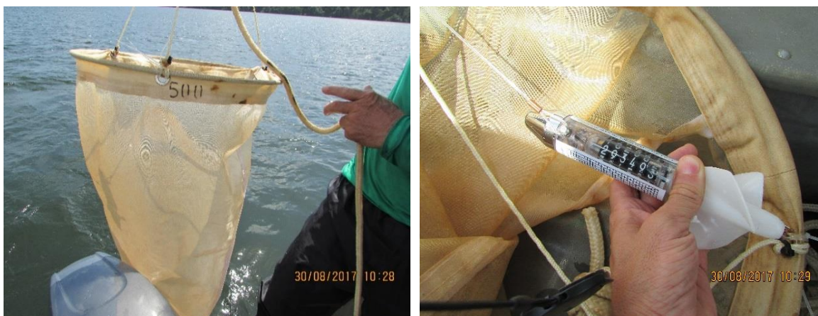
Foto 5.2.1-152 - Rede de ictioplâncton com fluxômetro utilizados para captura dos organismos e medição de volume filtrado durante as coletas. Autor: DTA, 2018.
