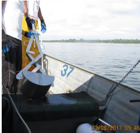
Foto 5.2.1-154 - Pegador do tipo Van Veen utilizado nas coletas de macroinvertebrados bentônicos. Autor: DTA, 2017.
