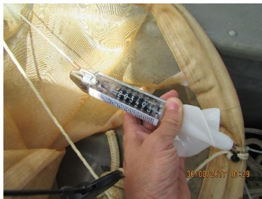
Foto 5.2.1-151 - Fluxômetro acoplado à rede de coleta de zooplâncton. Autor: DTA, 2018.
