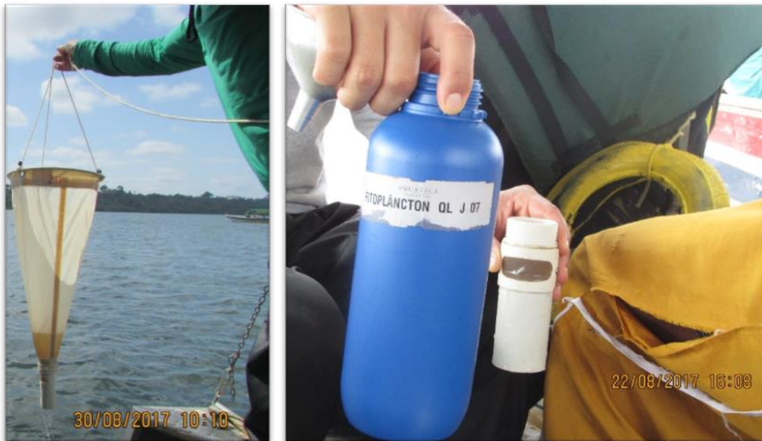
Foto 5.2.1-148 - Rede de fitoplâncton utilizada nas coletas com detalhamento no momento da passagem do material coletado para o frasco de preservação da amostra.
