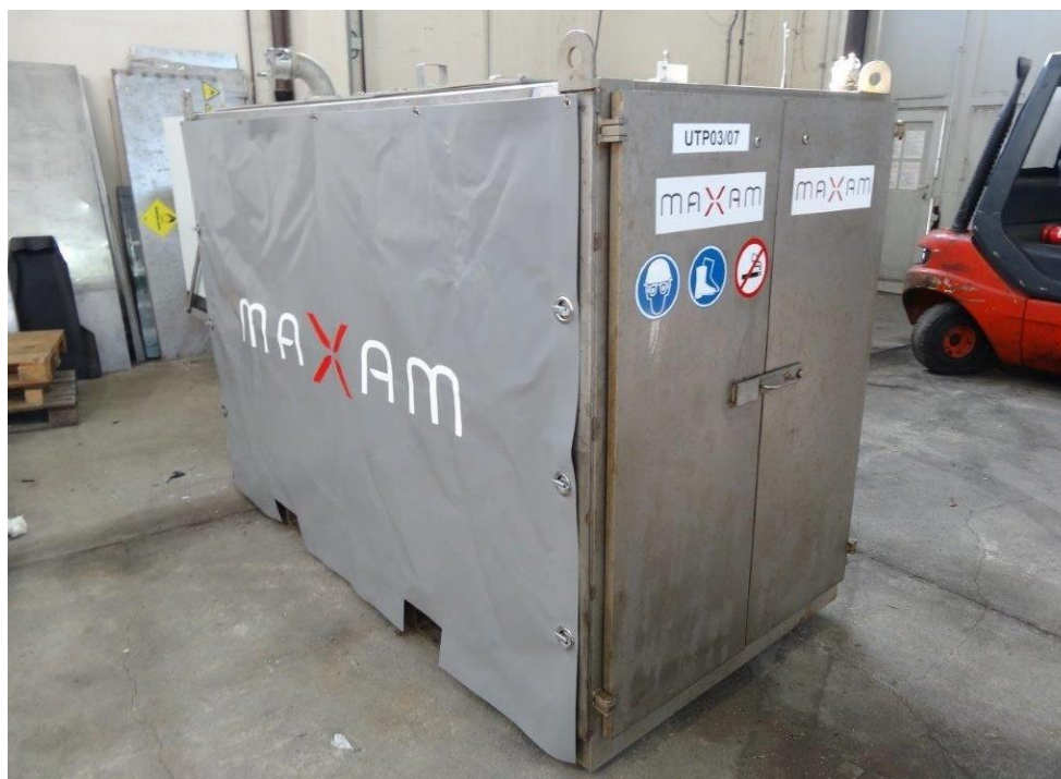
Figura 2.4.2-50 - Cassetes: armazenamento dos componentes da emulsão bombeada nos flutuantes das perfuratrizes.
