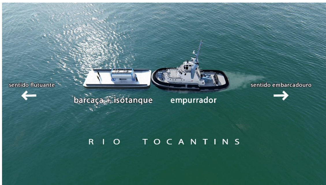
Figura 2.4.2-59 - A barcaça com o isotanque é rebocada até o local da detonação.
