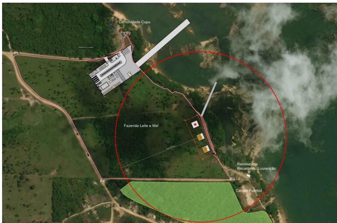
Figura 3.1.2-4 - Alternativa de locação do canteiro de obras e paiol, Fazenda leite e Mel – canteiro localizado ao norte da área e paiol, ao sul.
