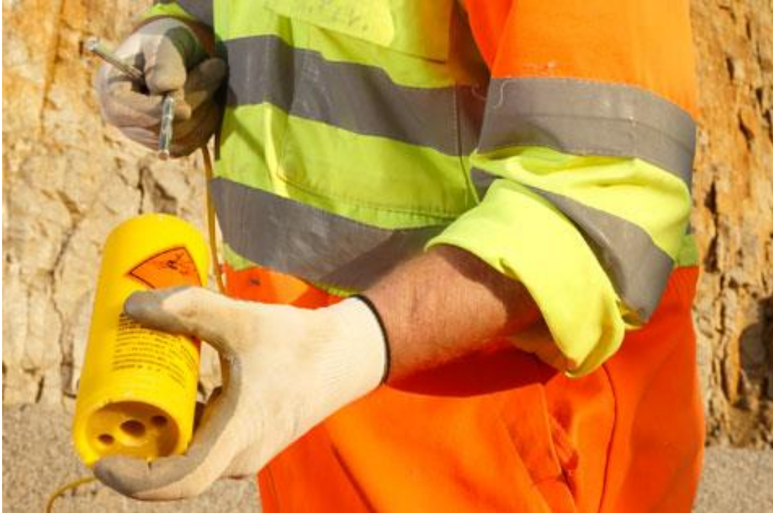
Figura 3.2.2-13 - Escorva com booster e linha silenciosa.
