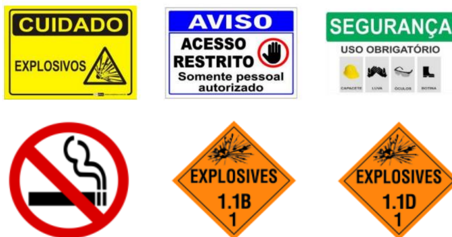
Figura 2.4.2-80 - Sinalização de proteção dos paióis.
