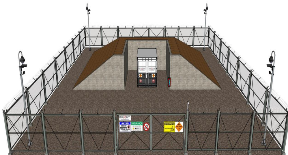
Figura 2.4.2-79 - Paiol entrincheirado, cerca de proteção com portão, câmeras de segurança e sinalização.
