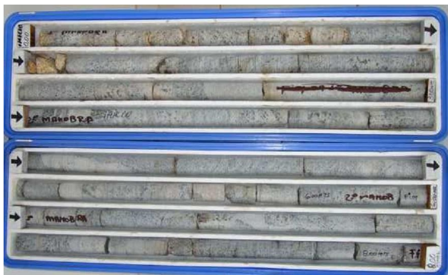
Figura 2.4.2-13 - Caixa de testemunhos com rocha granítica.
