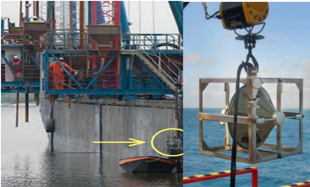
Figura 2.4.2-92 - À esquerda, flutuante de perfuração com Faunaguard acoplado. À direita, detalhe do hidrofone que emite as ondas sonoras.
