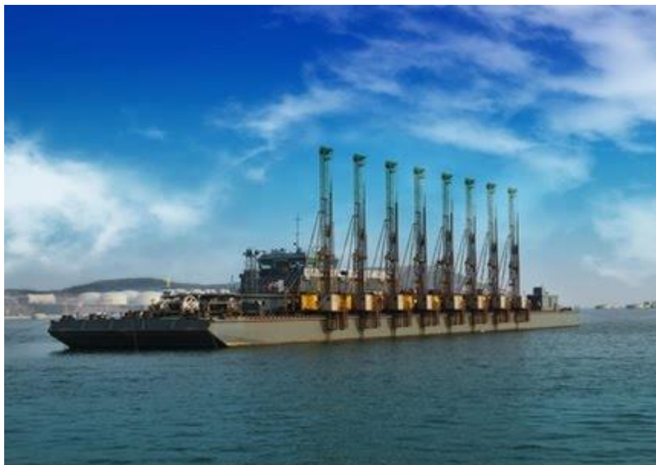
Figura 3.2.2-7 - Embarcação com torres de perfuração; derrocamento com uso de explosivos industriais.
