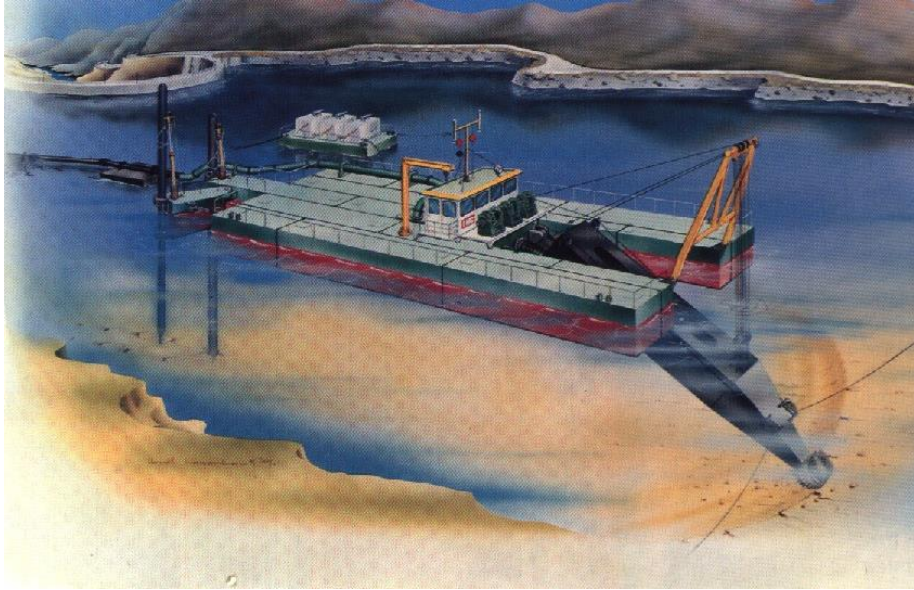
Figura 2.4.1-3 - Draga de sucção recalque em operação.
