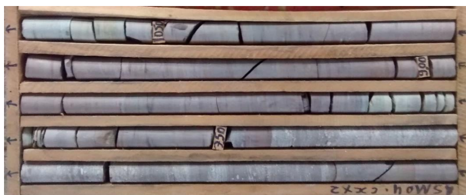
Figura 2.4.2-14 - Caixa de testemunhos com rocha granítica e basalto.
