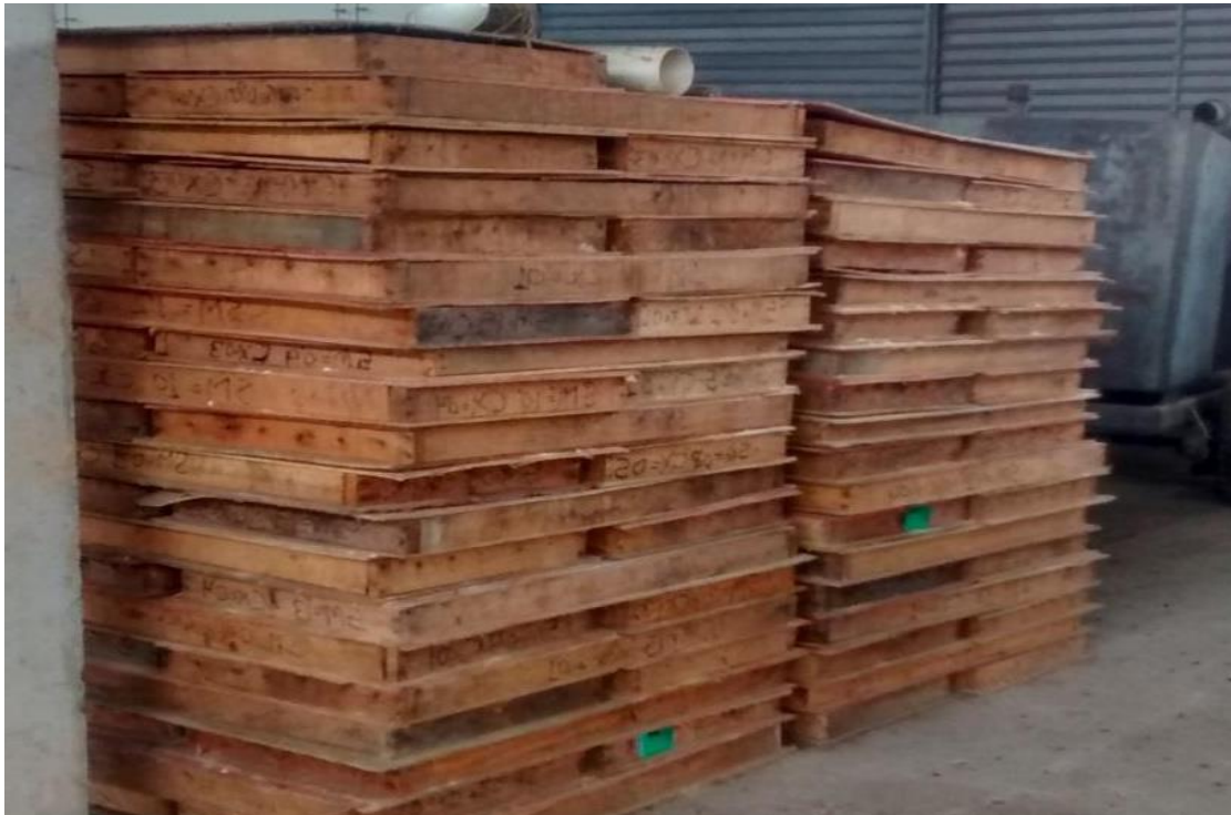
Figura 2.4.2-17 - Caixas de armazenamento de testemunhos de sondagem (Porto de São Francisco, Barcarena-PA, outubro de 2017).
