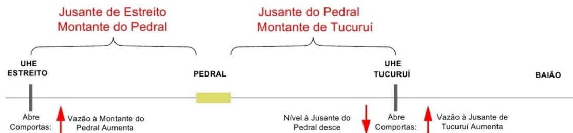
Figura 2.4.2-12 - Desenho esquemático do comportamento do rio a montante e a jusante do Pedral, em função da UHE Estreito e UHE Tucuruí.
