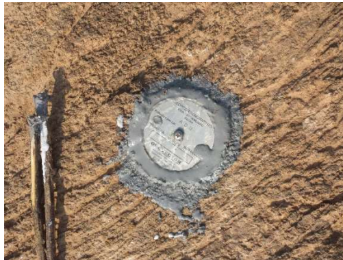
Figura 10: chapa em fixação a rocha, marco RN13-A.
