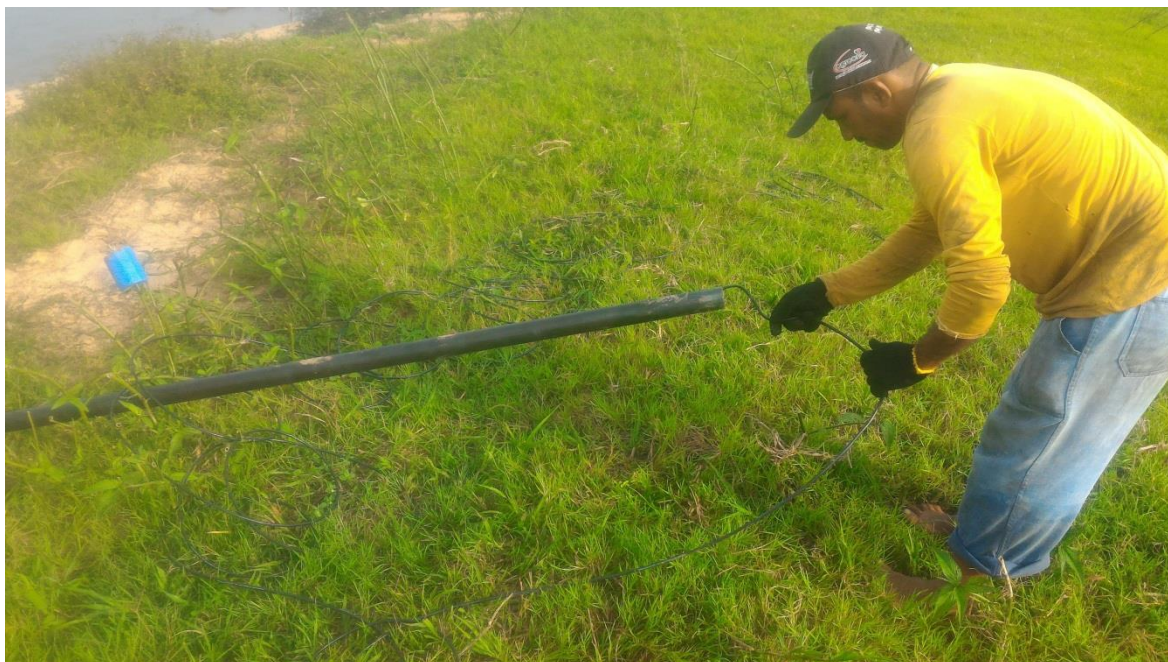
Figura 3: Passagem do sensor pelo tubo zincado.
