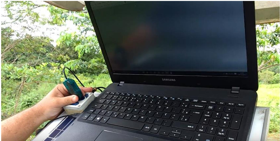
Figura 34: Caneta de interface ótica ligada ao computador e ao datalogger.
