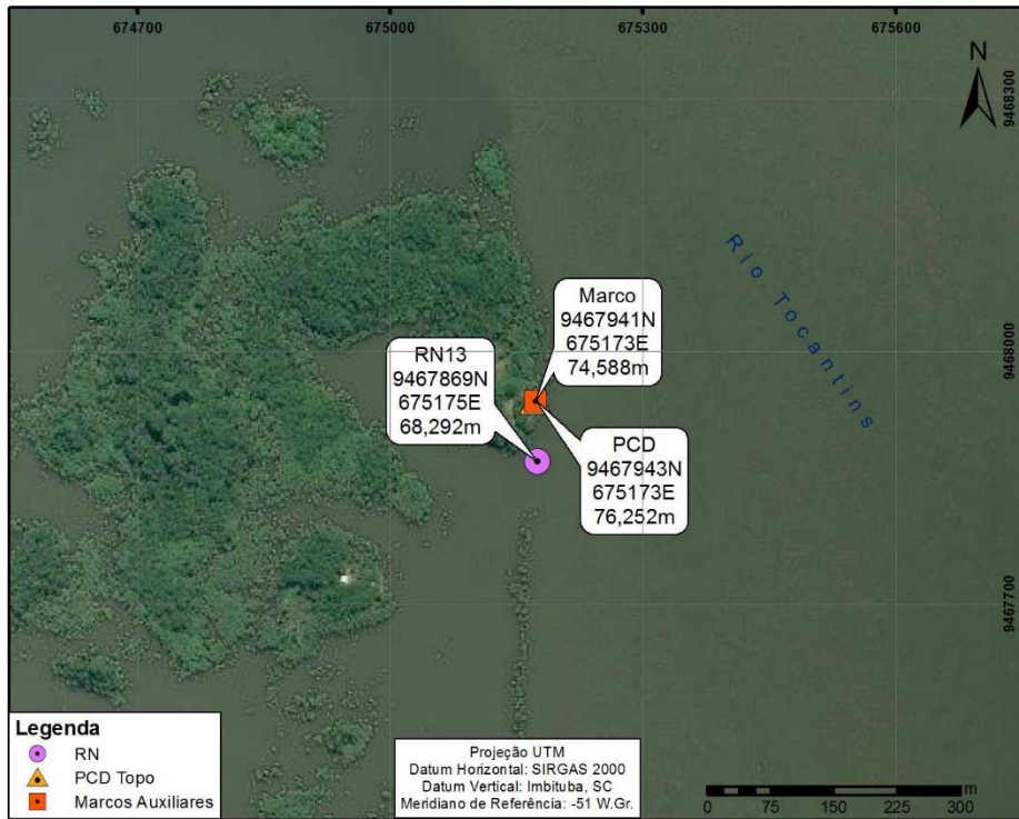
Figura 22: Locação RN13, PCD e Marco Auxiliar.
