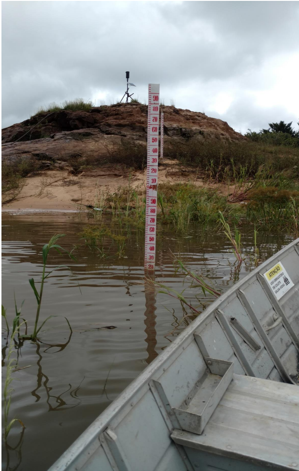
Figura 2: Linímetros e Linígrafo instalados no RN03.
