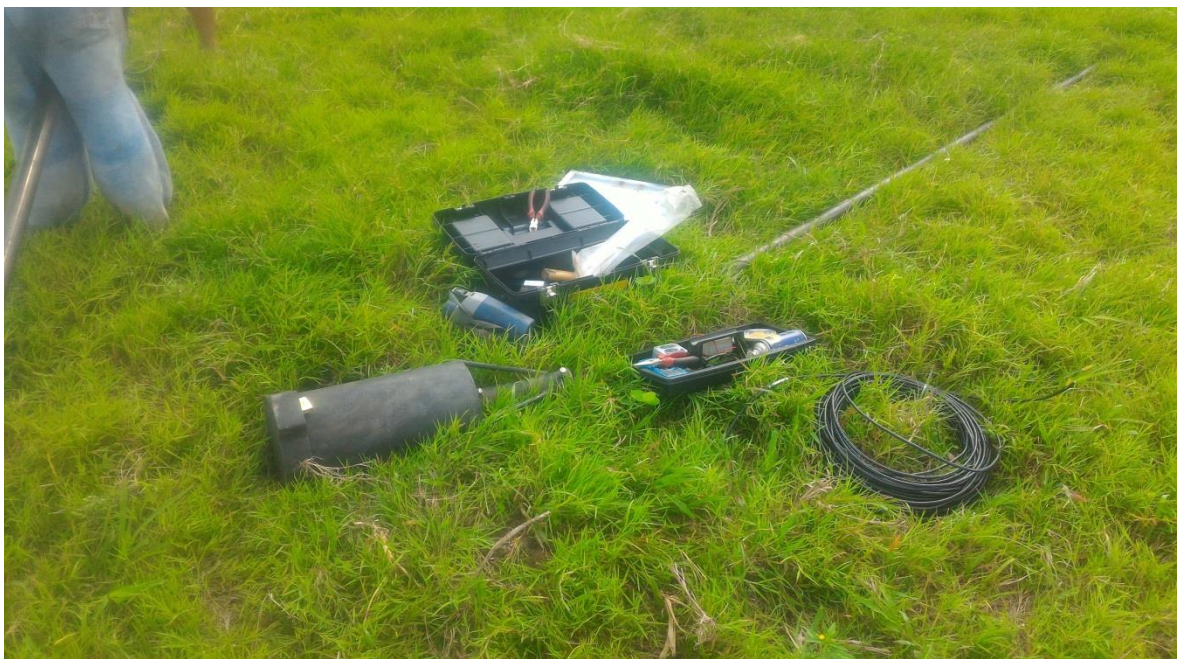
Figura 5: Caixa de acondicionamento com cadeado.
