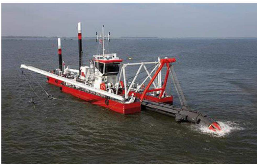
Figura 4-11 – Exemplo de Dragagem de Sucção e Recalque (IHC, 2017)
