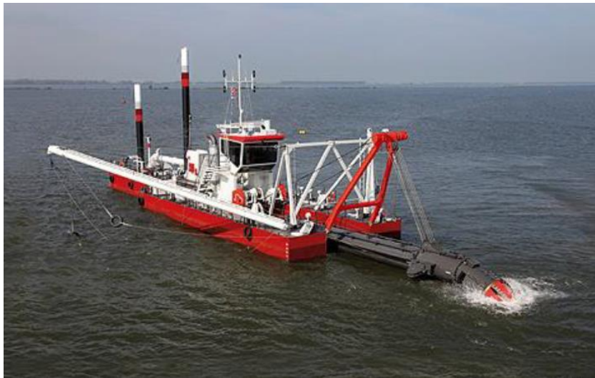
Figura 7.1.1-2 - Exemplo de Draga de Sucção e Recalque.
