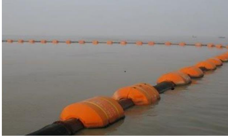
Figura 7.1.1-3 - Figura ilustrativa de Tubulação PEAD com flutuante.
