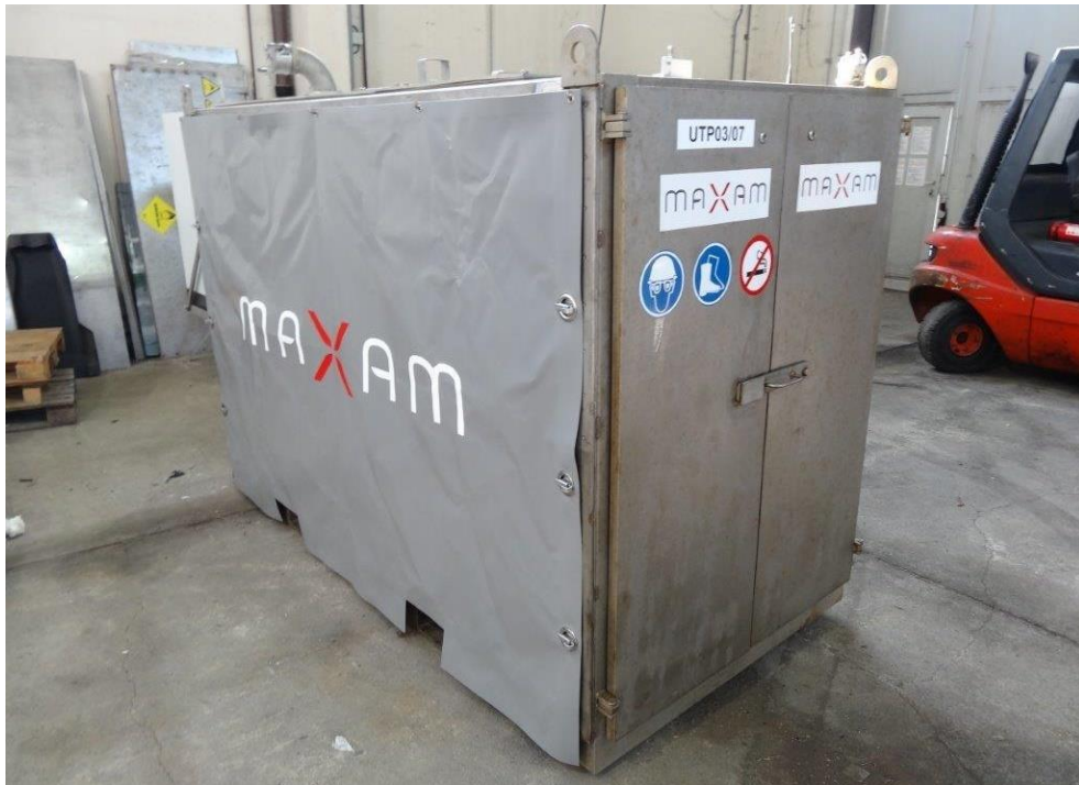
Figura 7.1.2-3 - Cassetes: armazenamento dos componentes da emulsão bombeada nos flutuantes das perfuratrizes.
