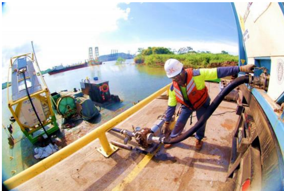
Figura 7.1.2-2 - Abastecimento do isotanque em flutuante que alimentará os cassetes nos flutuantes das perfuratrizes.
