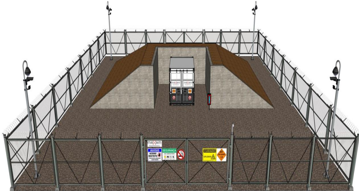
Figura 7.1.3-4 - PaioI entrincheirado, cerca de proteção com portão, câmeras de segurança e sinalização.
