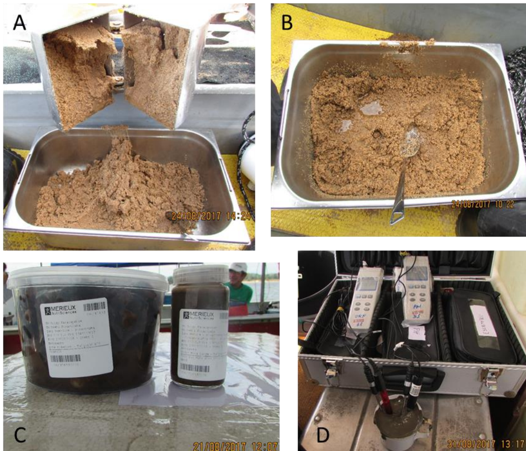
Figura 5.1.5-2 - Materiais utilizados na coleta de sedimentos: Amostrador Van Veen (A); Bandejas e colheres de aço inoxidável (B); Frascos utilizados (C); obtenção dos dados em campo com multiparâmetro (D)
