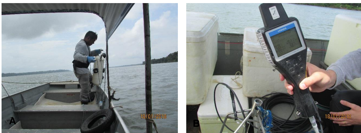
Figura 5.1.5-4 - Equipamentos utilizados nas medições de turbidez: A) Garrafa Van Dorn e B) Sensor Multiparâmetro HORIBA U52-G
