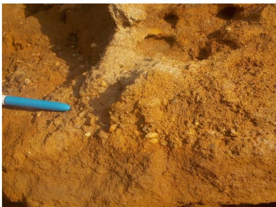
Foto 5.1.4-123 - Camadas de areia média a grossa, intercalada com cascalho de quartzo, quartzito arredondado a subarredondado com diâmetros de 1 a 3 cm, laterizados que ocorrem na Planície de inundação da Ilha Grande Jutaí (0651051x9635121).
