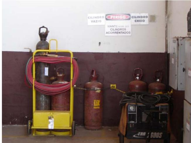
Foto 6.8 – Cilindros utilizados em Operação de Oxi-corte
