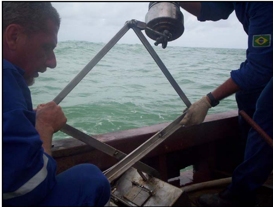
Figura 3.3: Lançamento de amostrador Van Veen para coleta de sedimento para análise do bentos.
