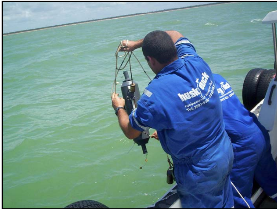
Figura 3.2: Lançamento de garrafa de Van Dorn para coleta de água para análise do fitoplâncton.
