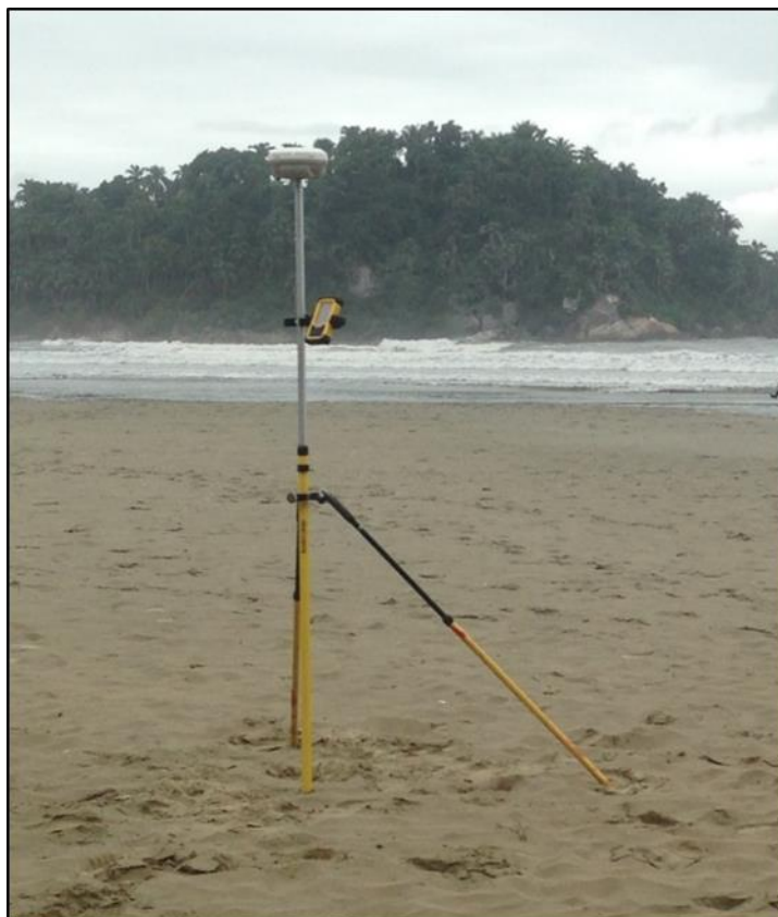
Figura 2-3. Receptor móvel Trimble R4 pronto para levantamento.
