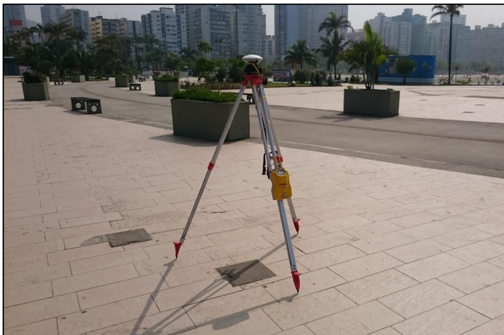
Figura 2-2. Receptor estático Trimble 5700 adquirindo dados na região do Emissário Submarino de Santos.
