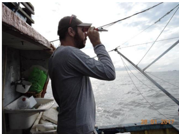
Figura 4-9: Técnico de campo realizando a aferição da salinidade com auxílio de salinômetro portátil.
