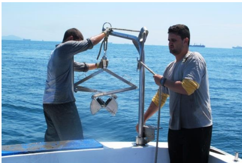
Figura 3-2: Coleta de amostra utilizando-se pegador de fundo "Van Veen".
