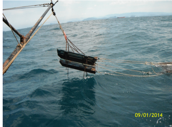
Figura 2. Rede de arrasto de fundo com portas posicionadas para lançamento.
