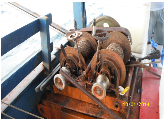
Figura 3. Guinchos utilizados para içar as redes de arrasto.
