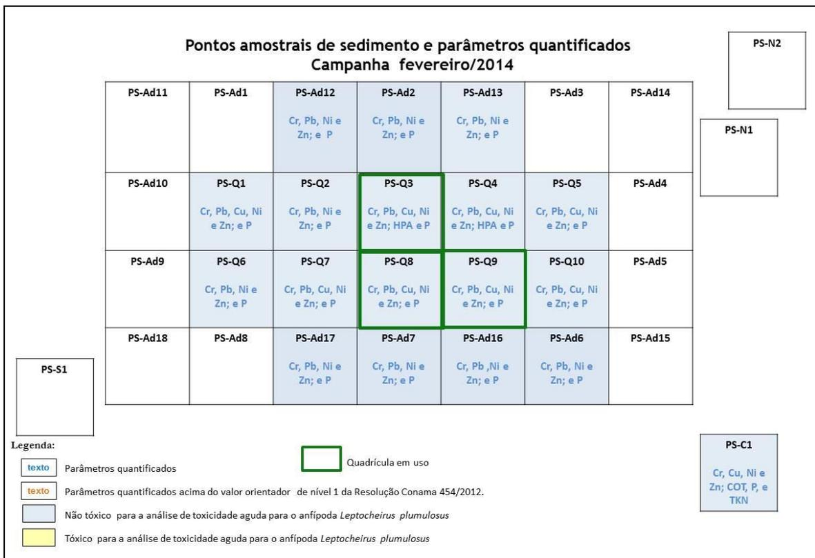
Figura 17.3.1-5. Esquema ilustrativo contemplando os pontos amostrais e os parâmetros quantificados durante a Campanha de fevereiro de 2014.
