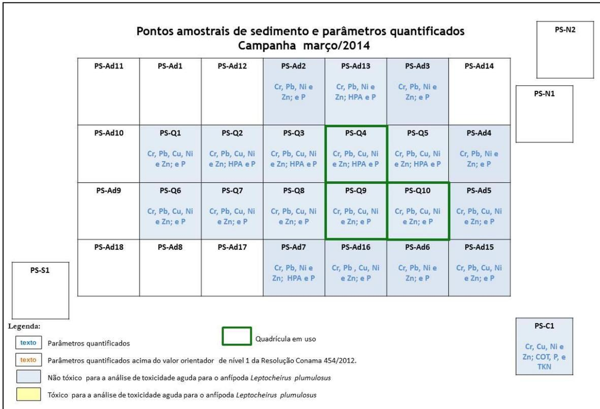
Figura 17.3.1-8. Esquema ilustrativo contemplando os pontos amostrais e os parâmetros quantificados durante a Campanha de março de 2014.
