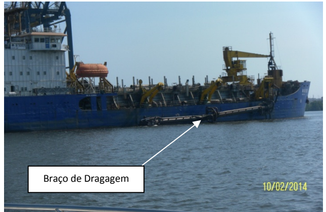
Figura 4. Detalhe do início da descida da bomba de sucção para o início da dragagem.
