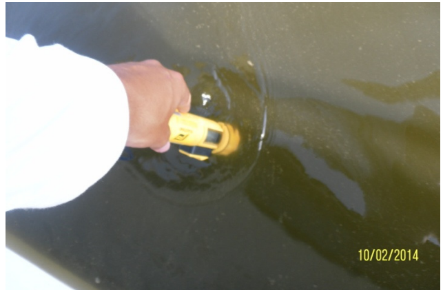
Figura 14. Medição da profundidade da coluna d'água utilizando profundímetro.
