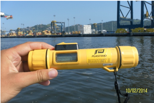
Figura 13. Equipamento utilizado para medir a profundidade em cada ponto de amostragem.
