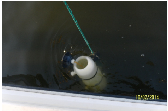
Figura 16. Amostragem de água superficial utilizando garrafa Van Dorn.
