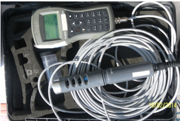
Figura 15. Sonda multiparamétrica da marca HANNA, modelo HI 9828, utilizada para medição in situ dos parâmetros físico-químicos.
