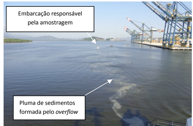
Figura 10. Posicionamento da embarcação de coleta na direção da pluma de sedimentos formada pelo overflow .
