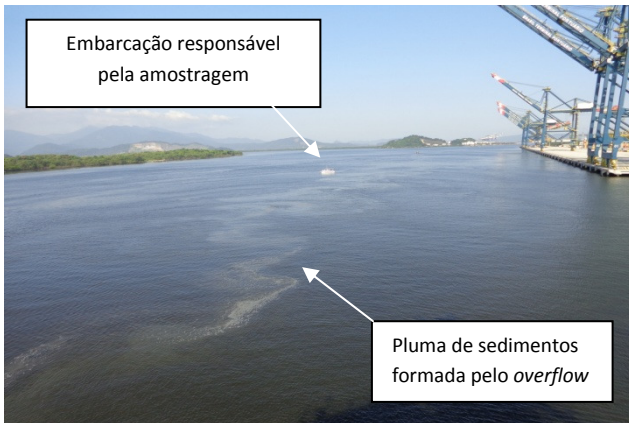
Figura 9. Posicionamento da embarcação de coleta na direção da pluma de sedimentos formada pelo overflow .
