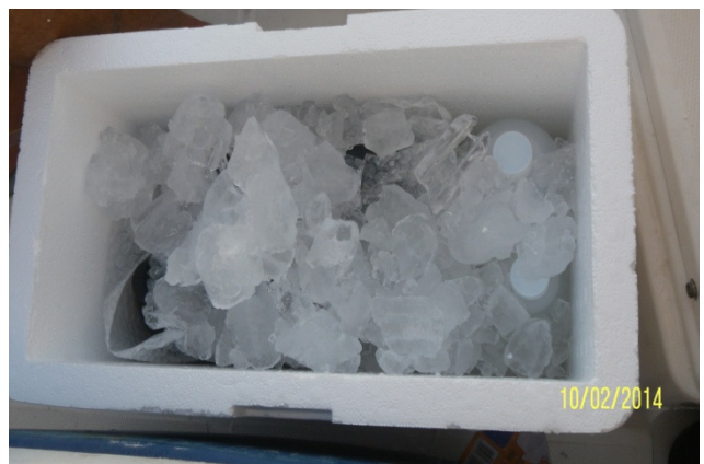
Figura 18. Preservação das amostras de água superficial em caixas térmicas com gelo.
