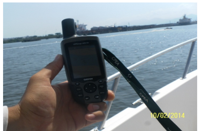
Figura 12. Georreferenciamento dos pontos de amostragem, utilizando receptor GPS da marca Garmin , modelo GPSmap 60CSx .
