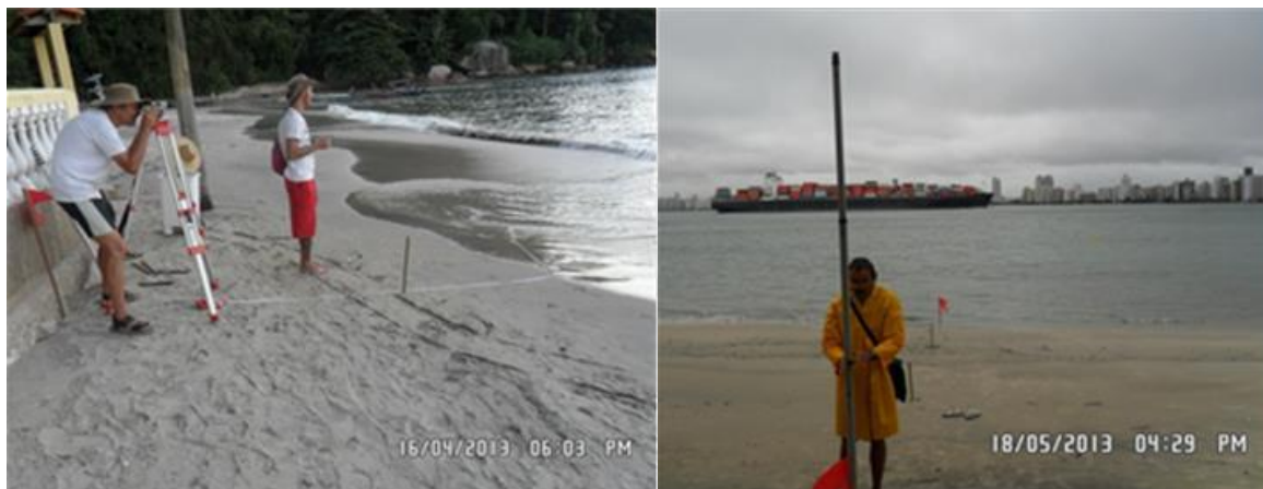
Figura 8.2.2.1-4. Leitura da altura da praia com auxílio de nível topográfico e baliza de Emery.
