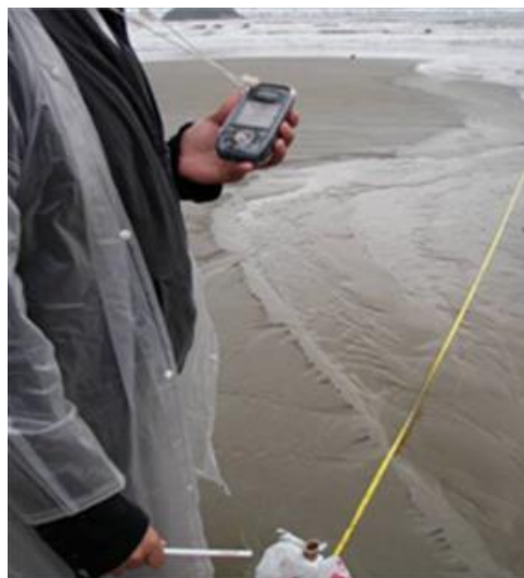
Figura 8.2.2.1-3. Leitura do posicionamento de um dos pontos (coleta) do perfil com uso de aparelho GPS (Itar-03).
