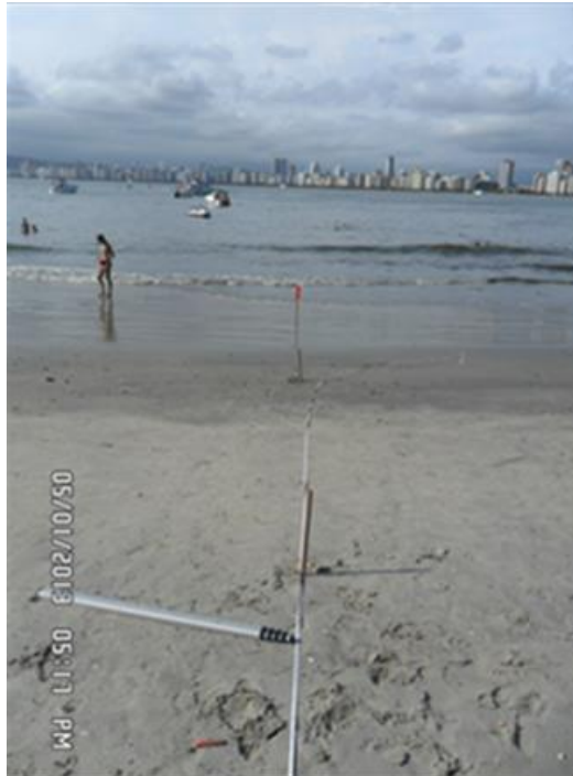
Figura 8.2.2.1-2. Alinhamento, segmentação (balizas) e medição da largura dos terços da pós-praia (Góes-04).
