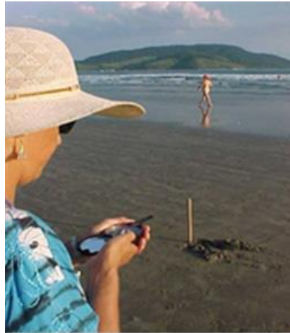
Figura8.2.2.2-1. Medição da ortogonal de ondas com bússola geológica.
