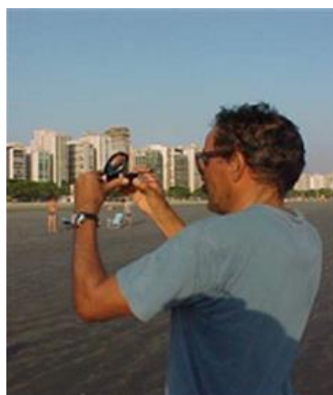
Figura 8.2.1-3. Posicionamento do perfil praial (perpendicular à linha de costa) utilizando a visada da bússola geológica do tipo Brunton e tendo como mira o ponto inicial fixo do perfil.
