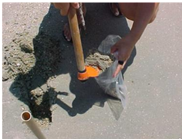
Figura 8.2.2.3-1. Coleta de sedimento no terço inferior do estirâncio, a 0-2,0 cm de profundidade.
