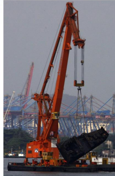
Guindaste retira parte da embarcação que, transferida para o cais (abaixo), é recortada para o transporte
