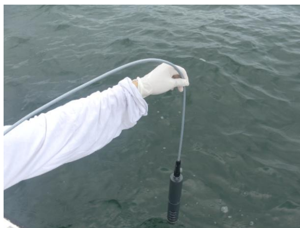
Figura 8. Medição dos parâmetros físico-químicos in situ , da água, utilizando a sonda multiparamétrica da marca HANNA modelo HI 9828.
