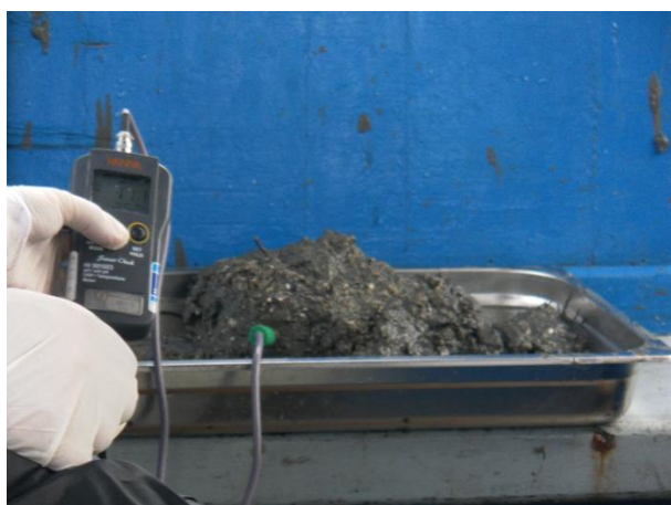
Figura 3. Medição dos parâmetros físico-químicos in situ , do sedimento, utilizando a sonda multiparamétrica da marca HANNA modelo HI 991003.
