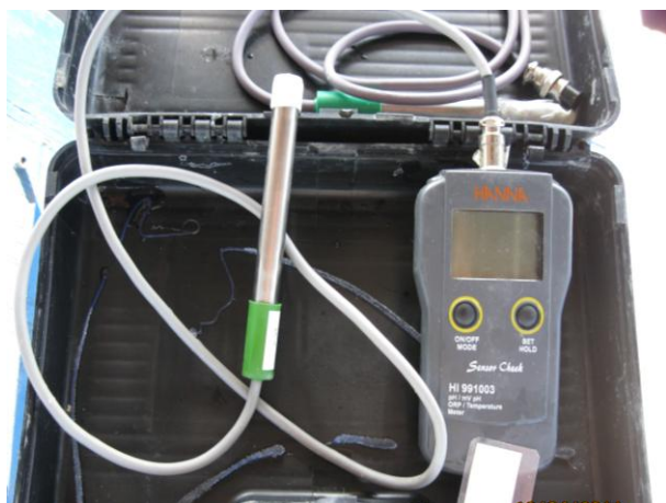
Figura 1. Sonda multiparamétrica da marca HANNA modelo HI 991003, utilizada para as medições físico-químicas in situ , das amostras de sedimento.
