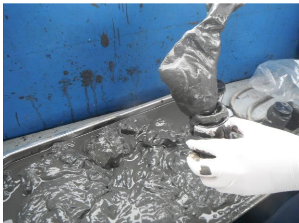
Figura 5. Acondicionamento do sedimento superficial em frascaria adequada com espátula de aço inox.
