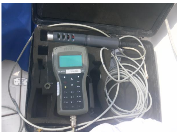
Figura 7. Sonda multiparamétrica da marca HANNA modelo HI 9828, utilizada para as medições físico-químicas in situ , da água de fundo. .
