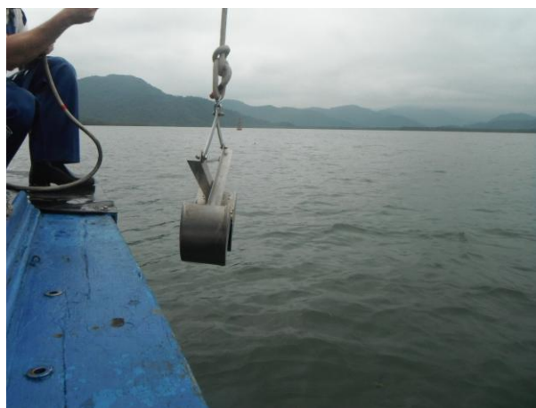
Figura 2. Detalhe do lançamento da Draga van Veen para a amostragem de sedimento superficial.
