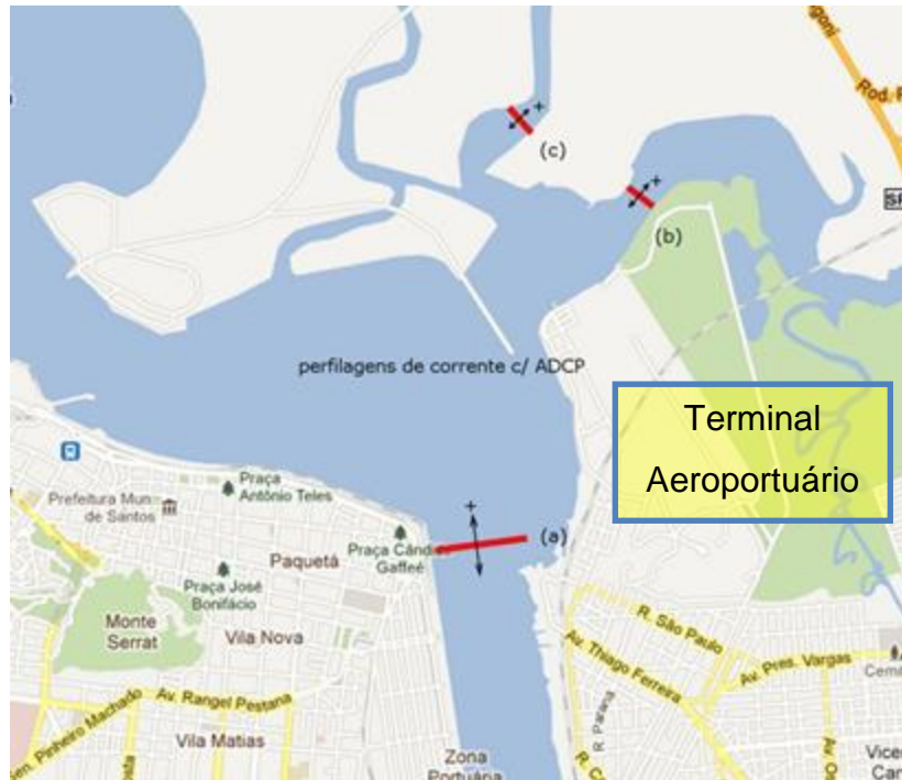
Figura 6.3.2-1. Localização das seções transversais de perfilações de corrente realizadas em 2011, no Canal do Porto de Santos (a), na saída do Canal de Bertioga (b) e na saída do Rio Diana (c). O sinal (+) indica o sentido da corrente, estuário acima.
