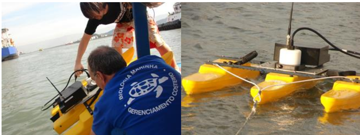
Figura 6.3.2-2. ADCP Sontek 1000 kHz, montado num trimaran, com sistema de transmissão de dados via rádio (Wi-Fi).
