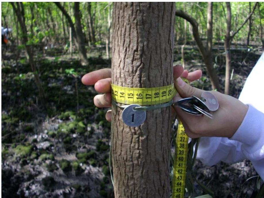
Figura 15.3.2-5. Foto ilustrando a tomada de medidas de perímetro à altura do peito (PAP) e placa de identificação individual.
