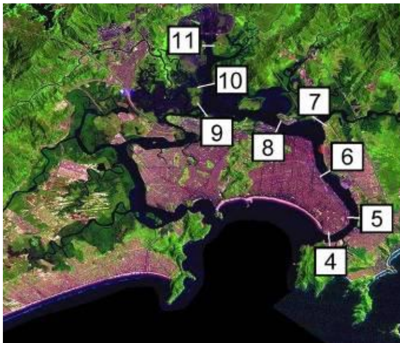
Figura 6.2-1. Localização das seções de coletas para as medições de marés, correntes, salinidade, temperatura e sólidos em suspensão (FRF, 2008).
