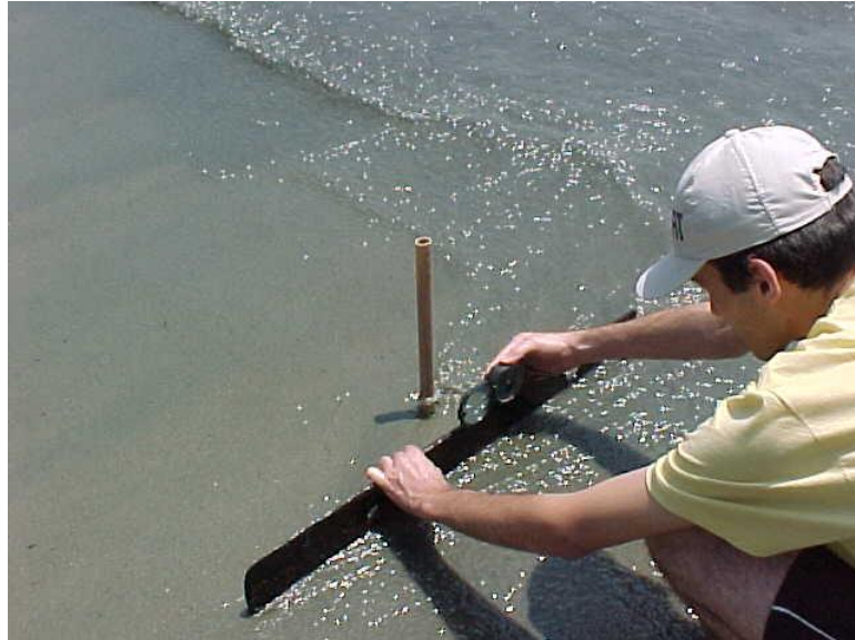
Figura 8.2.2.1-4. Leitura da declividade da praia na linha d'água (limite inferior do estirâncio) com auxílio de bússola geológica do tipo Brunton.
