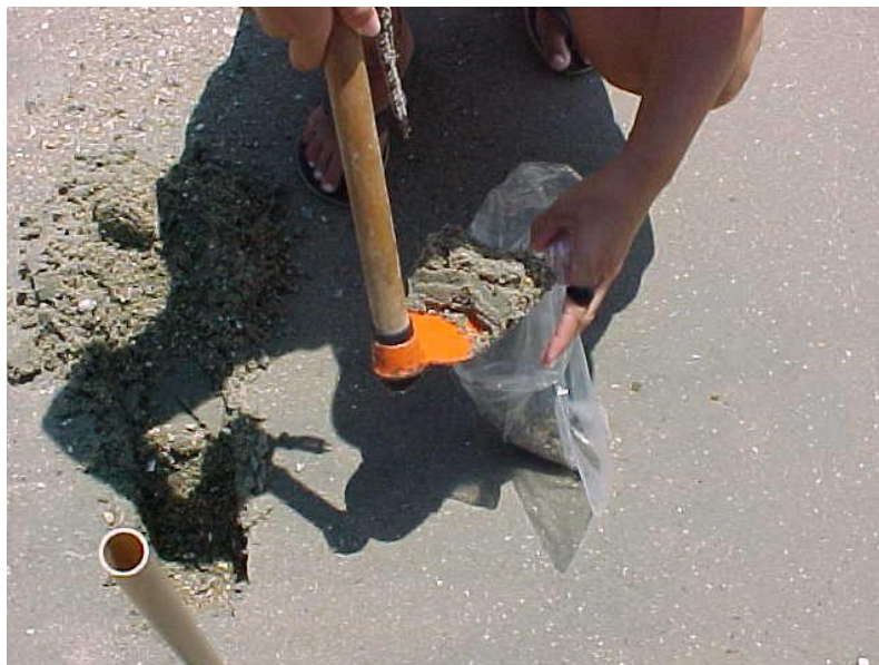
Figura 8.2.2.3-1. Coleta de sedimento no terço inferior do estirâncio, a 0-2,0 cm de profundidade.
