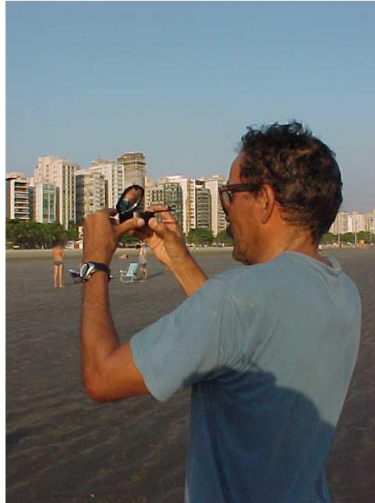
Figura 8.2.1-3. Posicionamento do perfil praiar (perpendicular à linha de costa) utilizando a visada da bússola geológica do tipo Brunton e tendo como mira o ponto inicial fixo do perfil.
