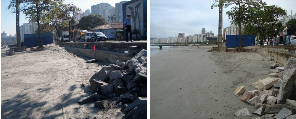
Figura 8.3.2.3-3. Redução do estoque sedimentar no perfil Stos-23 entre julho (esquerda) e novembro (direita) (05 de julho de 2010 e 13 de novembro de 2010, respectivamente).
