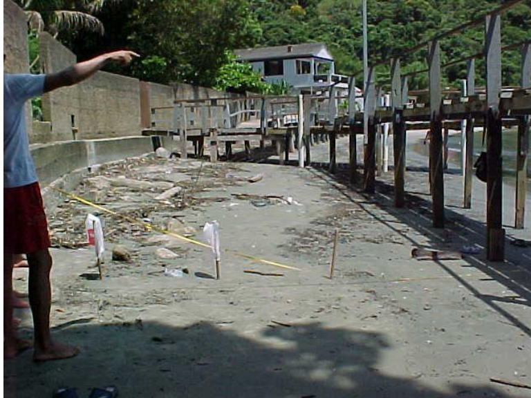
Figura 8.2.2.1-2. Alinhamento, segmentação (balizas) e medição da largura dos terços da pós-praia (Góes-04).
