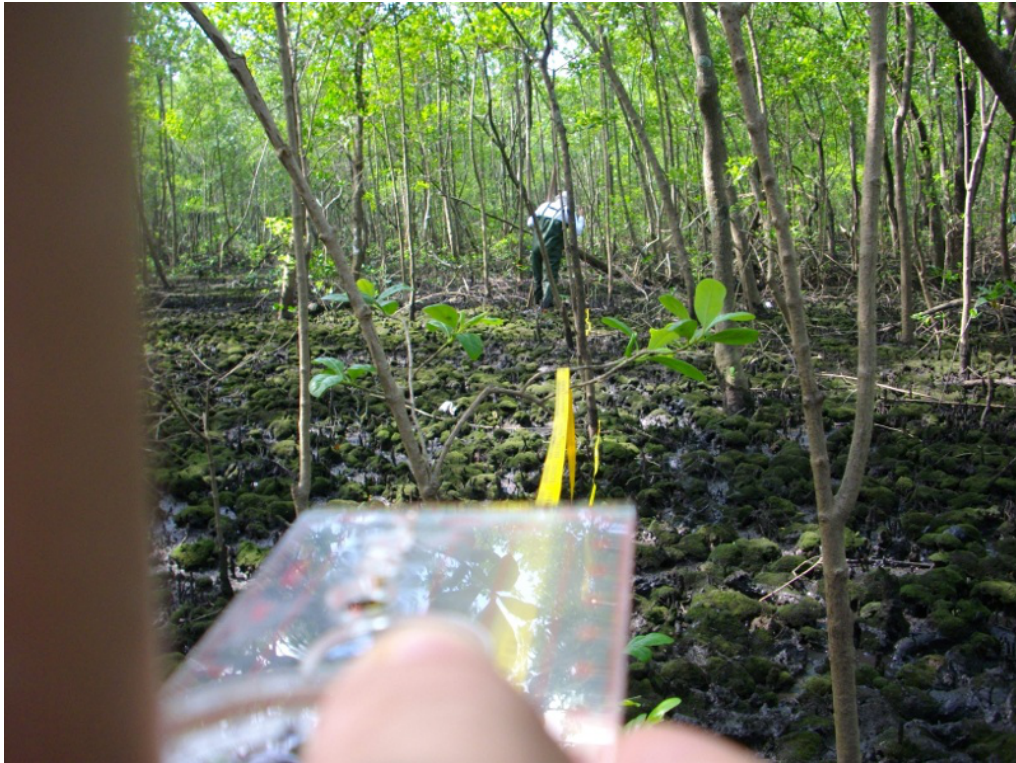
Figura 15.3.2-3: Foto de um dos técnicos posicionando a parcela permanente com auxílio de bússola, em projeção perpendicular ao curso d'água.
