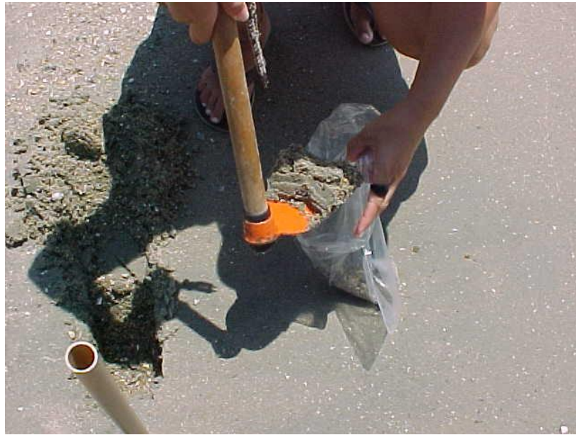
Figura 4.8.2.2-7. Coleta de sedimento no terço inferior do estirâncio, a 0,10m de profundidade.
