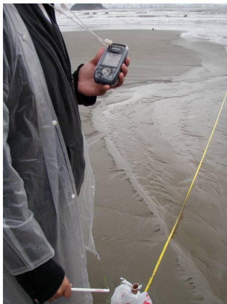
Figura 4.8.2.2-3. Leitura de posicionamento de ponto de coleta de amostra (terço inferior do estirâncio) com uso de GPS de mapeamento.
