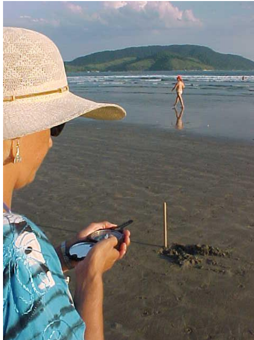
Figura 4.8.2.2-5. Medição da ortogonal de ondas com bússola geológica.
