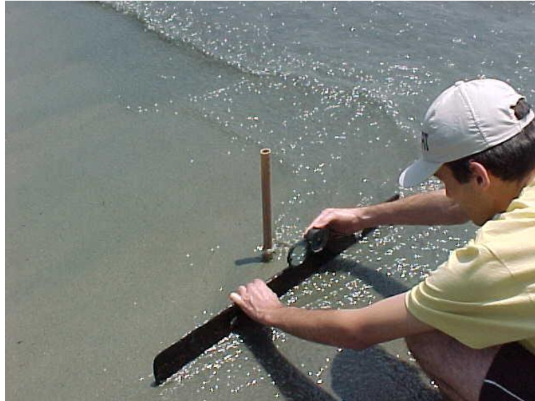
Figura 4.8.2.2-4. Leitura da declividade da praia na linha d'água (limite inferior do estirâncio) com auxílio de bússola geológica do tipo Brunton.
