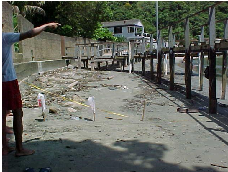
Figura 4.8.2.2-2. Demarcação e medição da largura dos terços da pós-praia (Góes-04/3 a ).
