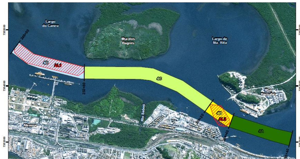
Figura 17.1-1. Localização do Trecho 4 e seus subtrechos (4A, 4B, 4C e 4D), em destaque para as manchas de material de sedimentação com qualidade inferior.
