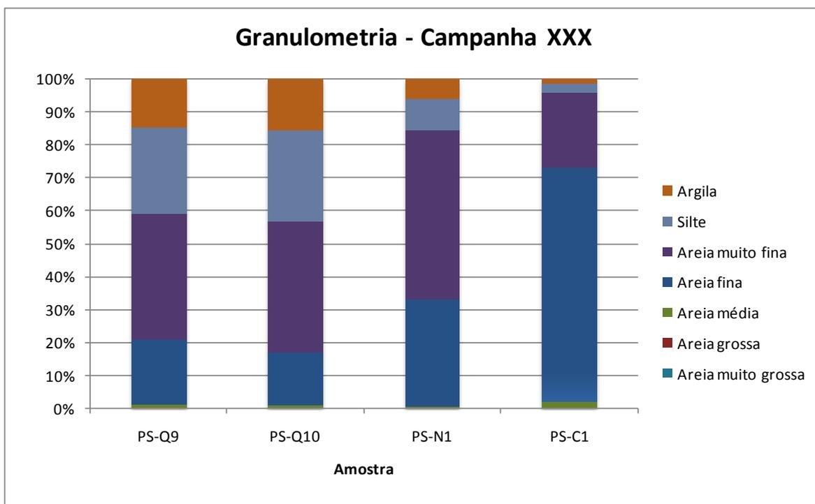
Figura 17.4.2-12. Composição granulométrica do sedimento das amostras PS-Q9, PS-Q10, PS-N1 e PS-C1 da Campanha XXX.
