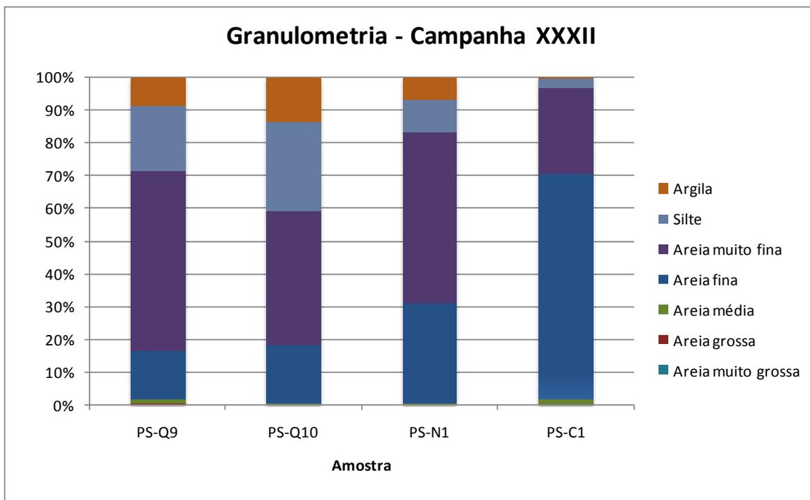
Figura 17.4.2-13. Composição granulométrica do sedimento das amostras PS-Q9, PS-Q10, PS-N1 e PS-C1 da Campanha XXXII.
