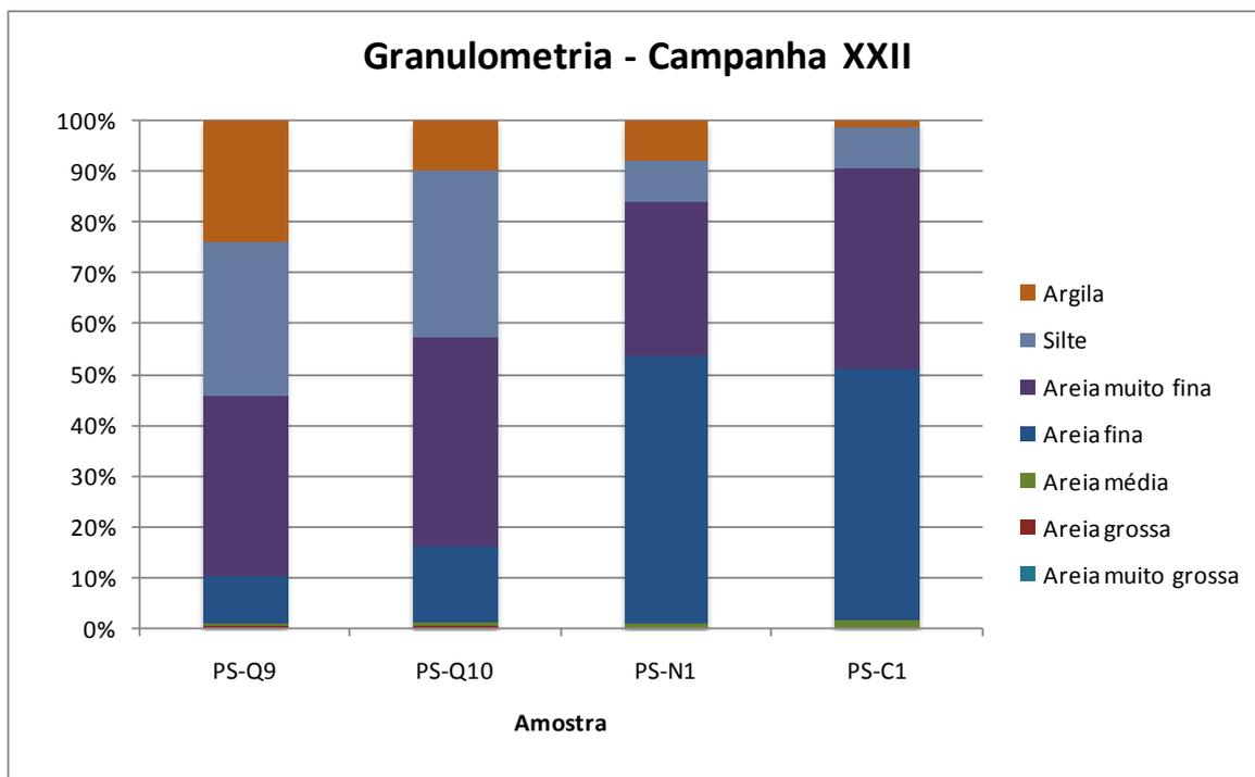
Figura 17.4.2-8. Composição granulométrica do sedimento das amostras PS-Q9, PS-Q10, PS-N1 e PS-C1 da Campanha XXII.
