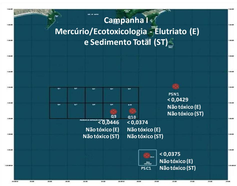
Figura 17.4.5-2. Variação espacial das concentrações de mercúrio e ensaios ecotoxicológicos no elutriato e no sedimento total, coletadas nos pontos PS-Q9, PS-Q10, PS-N1 e PS-C1, durante a Campanha I, realizada no dia 24 de março de 2011.
