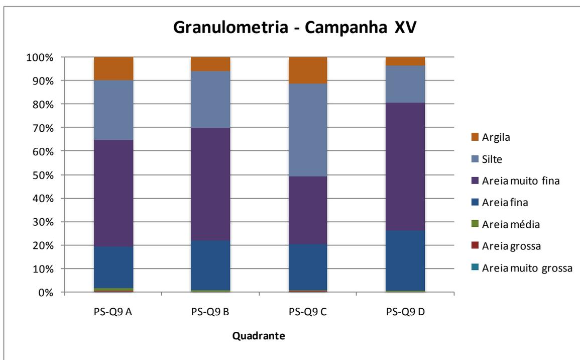
Figura 17.4.2-3. Composição granulométrica do sedimento das amostras PS-Q9 A, PS-Q9 B, PS-Q9 C e PS-Q9 D da Campanha XV.
