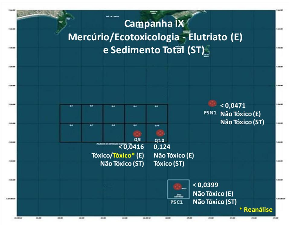
Figura 17.4.5-10. Variação espacial das concentrações de mercúrio e ensaios ecotoxicológicos no elutriato e no sedimento total, coletadas nos pontos PS-Q9, PS-Q10, PS-N1 e PS-C1, durante a Campanha IX, realizada no dia 19 de maio de 2011.
