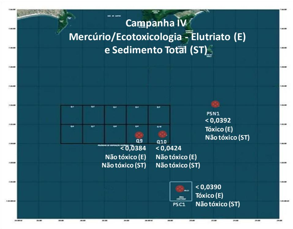
Figura 17.4.5-5. Variação espacial das concentrações de mercúrio e ensaios ecotoxicológicos no elutriato e no sedimento total, coletadas nos pontos PS-Q9, PS-Q10, PS-N1 e PS-C1, durante a Campanha IV, realizada no dia 12 de abril de 2011.
