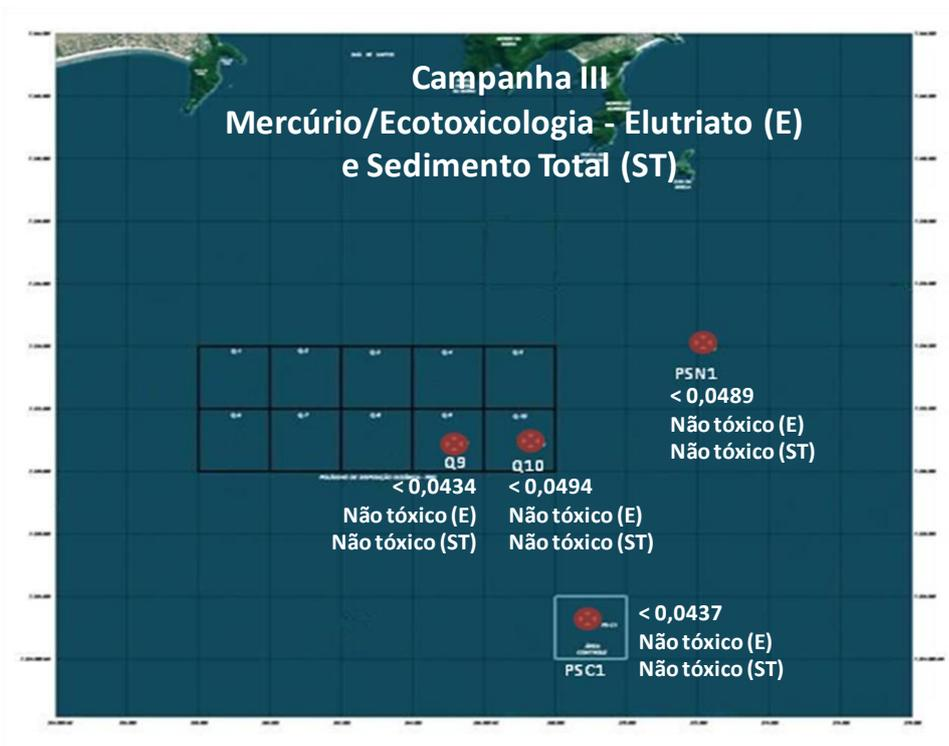
Figura 17.4.5-4. Variação espacial das concentrações de mercúrio e ensaios ecotoxicológicos no elutriato e no sedimento total, coletadas nos pontos PS-Q9, PS-Q10, PS-N1 e PS-C1, durante a Campanha III, realizada no dia 7 de abril de 2011.
