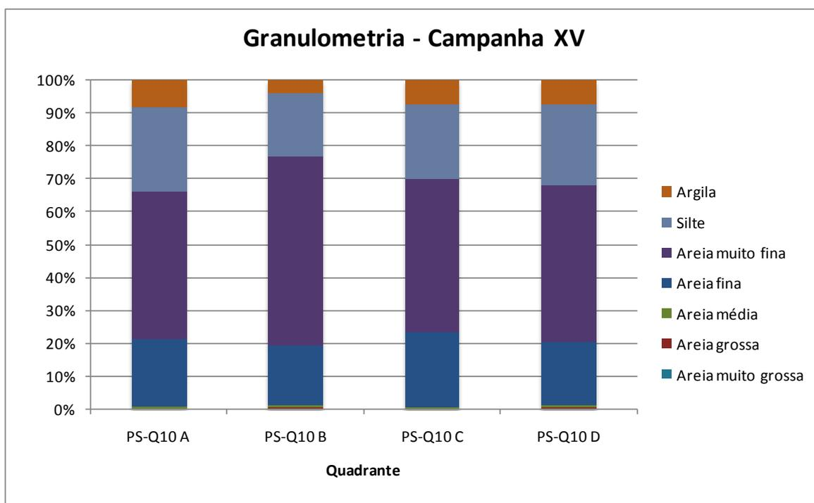
Figura 17.4.2-4. Composição granulométrica do sedimento das amostras PS-Q10 A, PS-Q10 B, PS-Q10 C e PS-Q10 D da Campanha XV.
