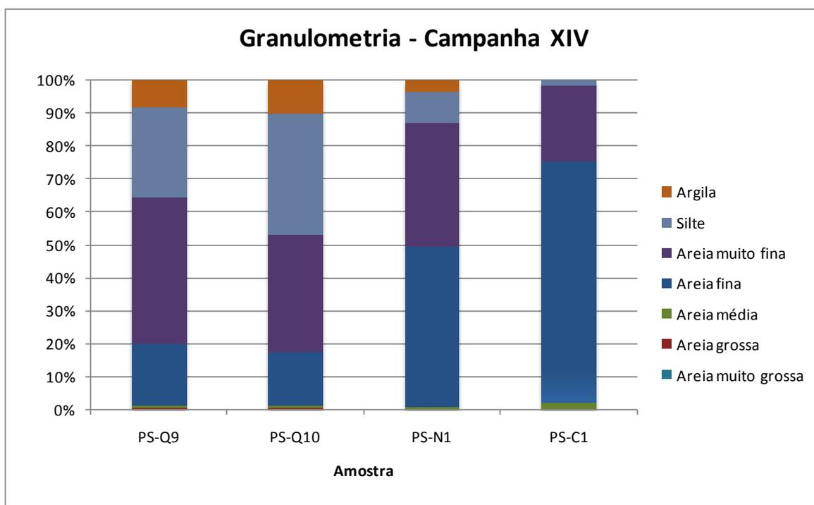
Figura 17.4.2-1. Composição granulométrica do sedimento das amostras PS-Q9, PS-Q10, PS-N1 e PS-C1 da Campanha XIV.
