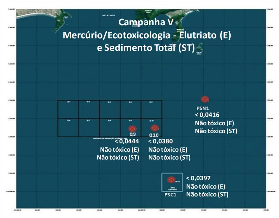
Figura 17.4.5-6. Variação espacial das concentrações de mercúrio e ensaios ecotoxicológicos no elutriato e no sedimento total, coletadas nos pontos PS-Q9, PS-Q10, PS-N1 e PS-C1, durante a Campanha V, realizada no dia 18 de abril de 2011.
