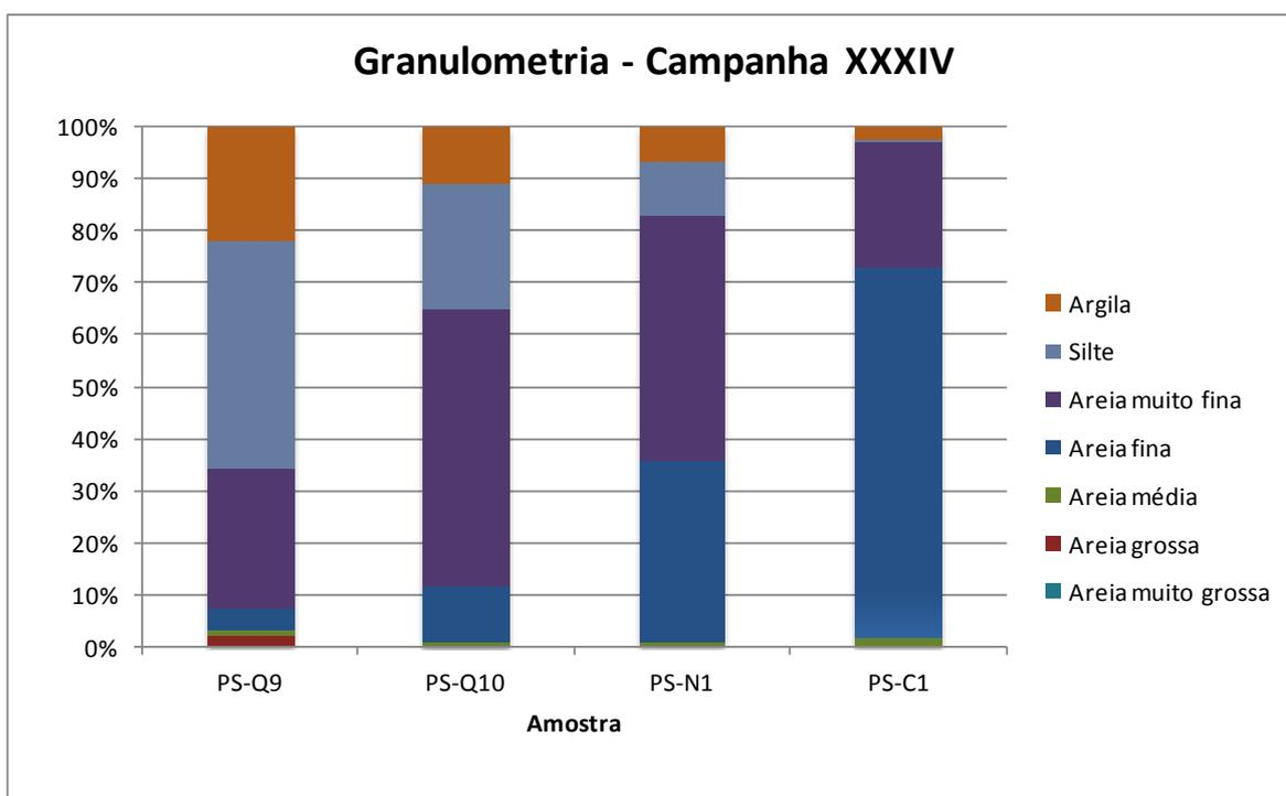
Figura 17.4.2-14. Composição granulométrica do sedimento das amostras PS-Q9, PS-Q10, PS-N1 e PS-C1 da Campanha XXXIV.
