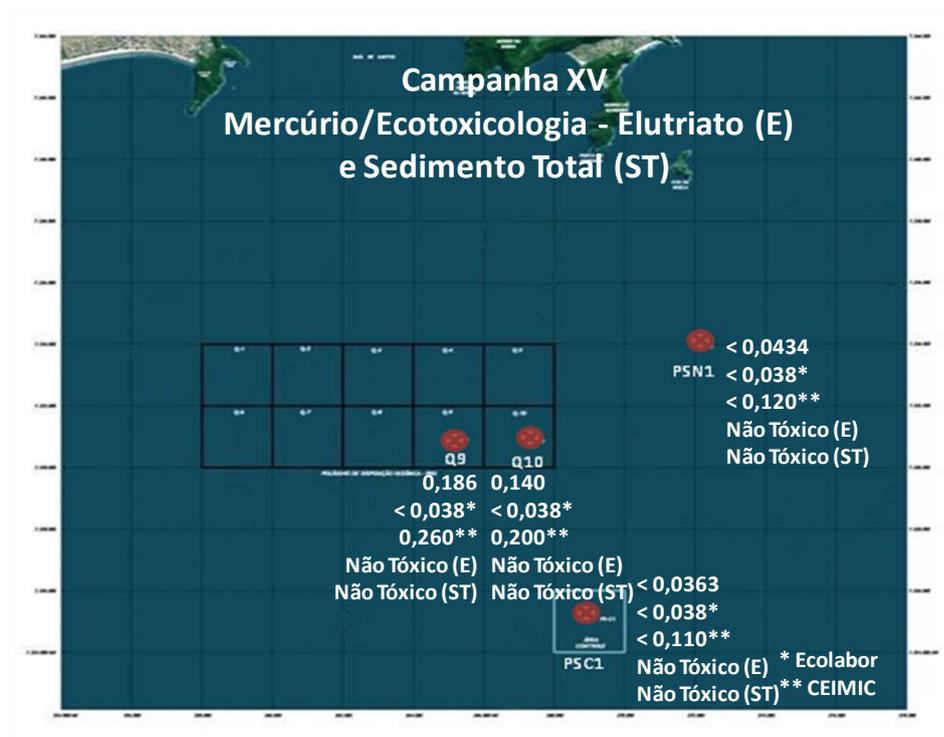
Figura 17.4.5-16. Variação espacial das concentrações de mercúrio e ensaios ecotoxicológicos no elutriato e no sedimento total, coletadas nos pontos PS-Q9, PS-Q10, PS-N1 e PS-C1, durante a Campanha XV, realizada no dia 30 de junho de 2011.
