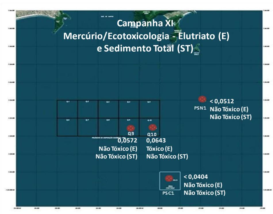
Figura 17.4.5-12. Variação espacial das concentrações de mercúrio e ensaios ecotoxicológicos no elutriato e no sedimento total, coletadas nos pontos PS-Q9, PS-Q10, PS-N1 e PS-C1, durante a Campanha XI, realizada no dia 03 de junho de 2011.
