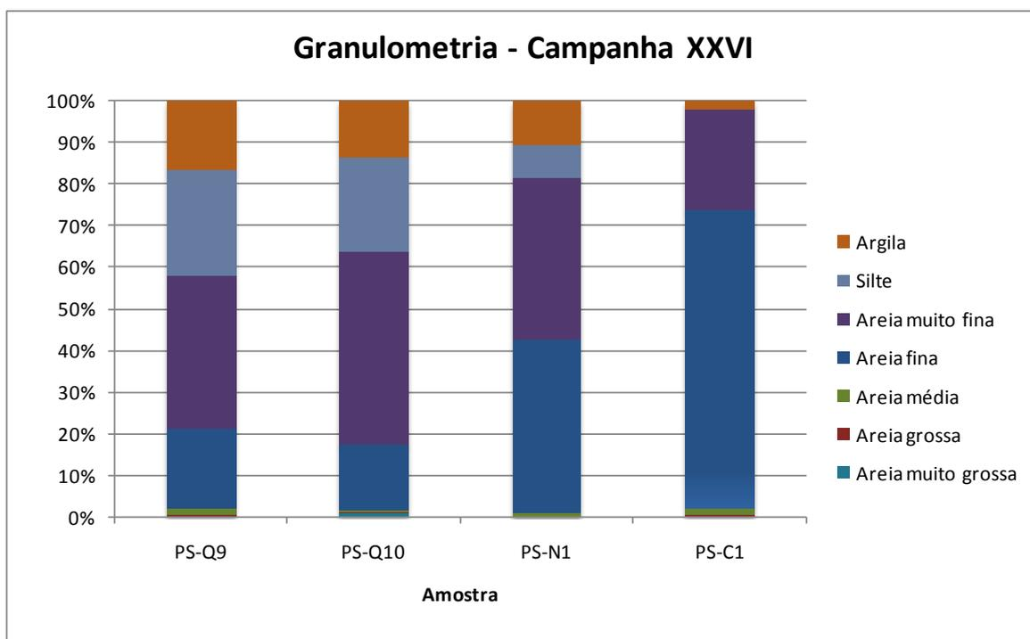
Figura 17.4.2-10. Composição granulométrica do sedimento das amostras PS-Q9, PS-Q10, PS-N1 e PS-C1 da Campanha XXVI.
