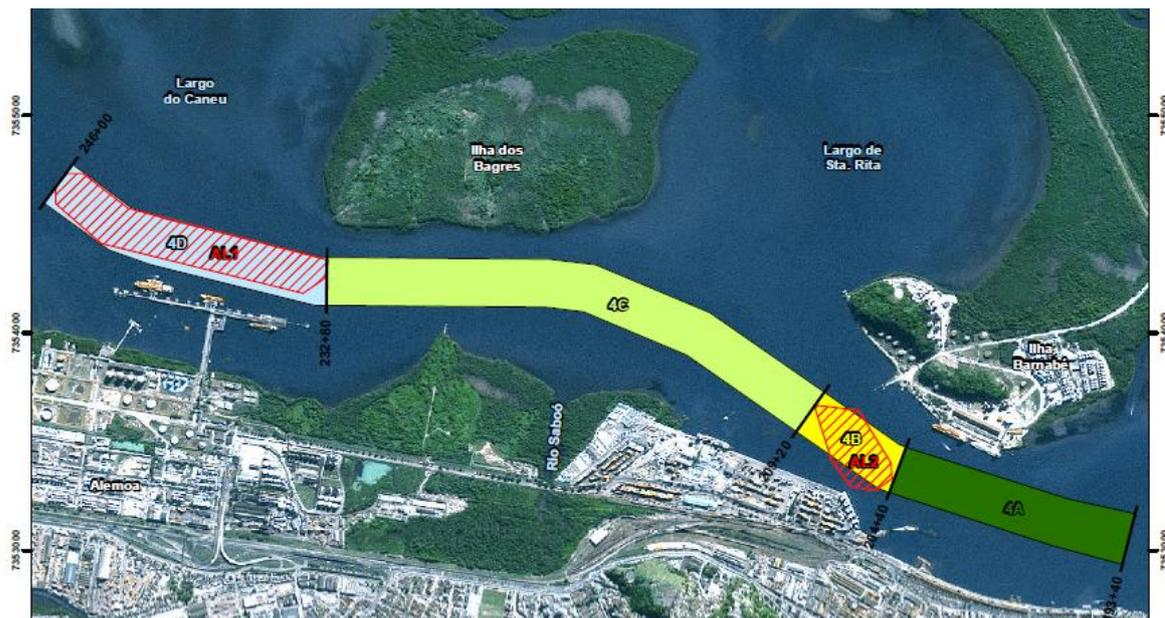
Figura 17.1-1. Localização do Trecho 4 e seus subtrechos (4A, 4B, 4C e 4D), em destaque para as manchas de material de sedimento com qualidade inferior.
