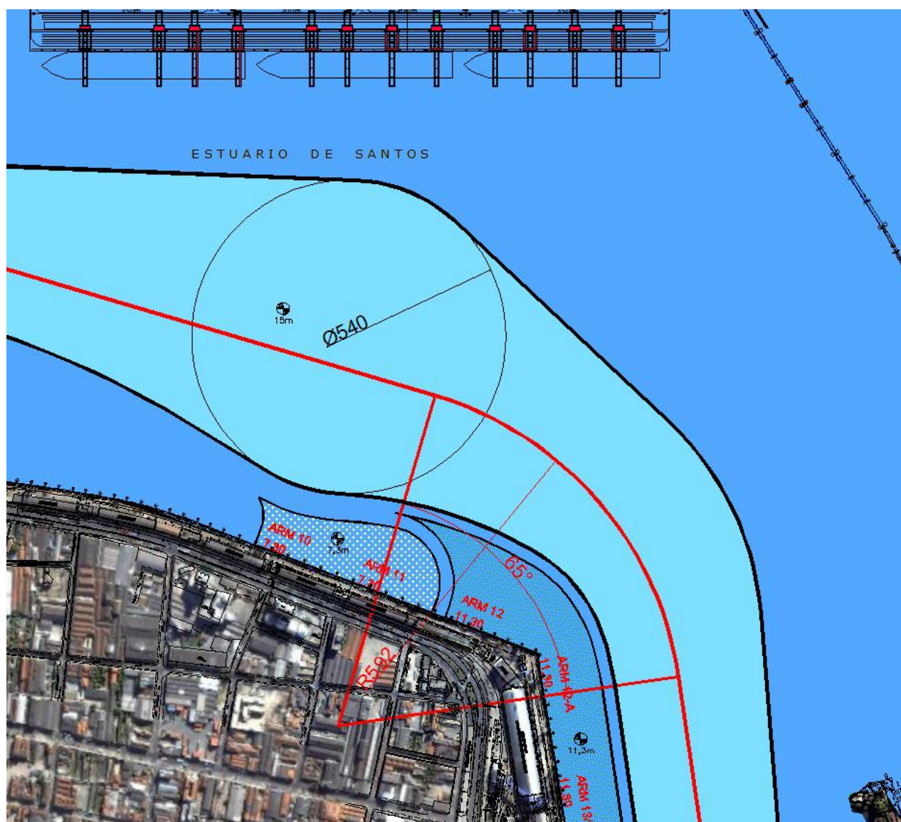
Figura 5-14 - Curva próxima ao Armazém 12. Destaca-se a delimitação de uma bacia de manobra entre o Armazém 10 e o Terminal da Embraport que favorece à manobrabilidade na curva. Raio da Curva = 592 m; Ângulo total = 65°.
