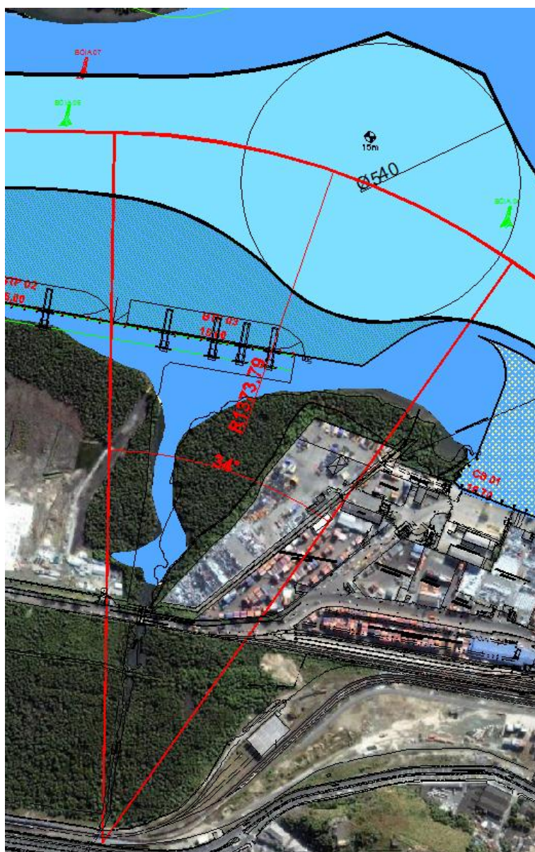
Figura 5-15 - Curva próxima ao Novo Terminal da BTP. Destaca-se a delimitação de uma bacia de manobra defronte o terminal que favorece à manobrabilidade na curva. Raio da Curva = 1.374 m; Ângulo total = 34°.
