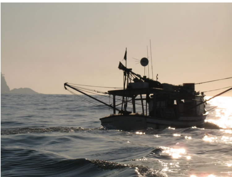
Figura 8.3.4-6: Barco com tangones abertos em operação para captura de camarão sete-barbas Xiphopenaues kroyeri .
