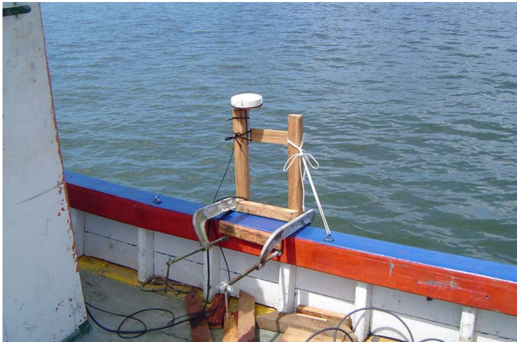
Suporte do ADCP e Antena do DGPS Instalados na Embarcação
