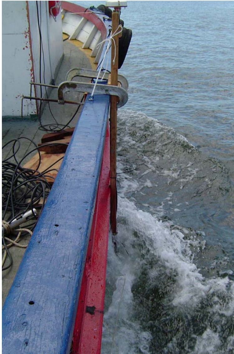
Suporte do ADCP e Antena do DGPS Instalados na Embarcação
