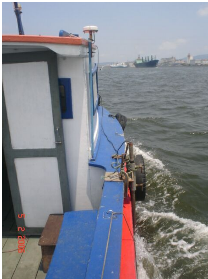
Transdutor do Ecobatímetro e Antena do DGPS Instalados na Embarcação
