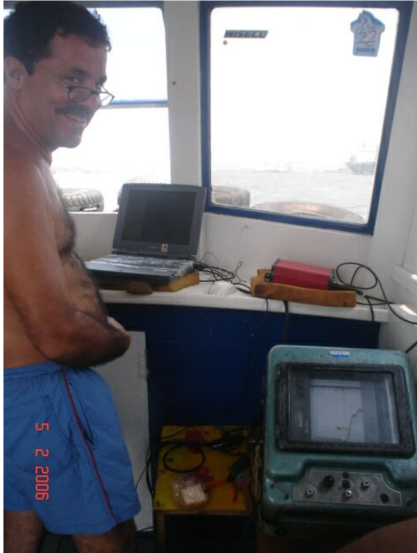
Lap-Top, DGPS e Ecobatímetro Instalados na Embarcação
