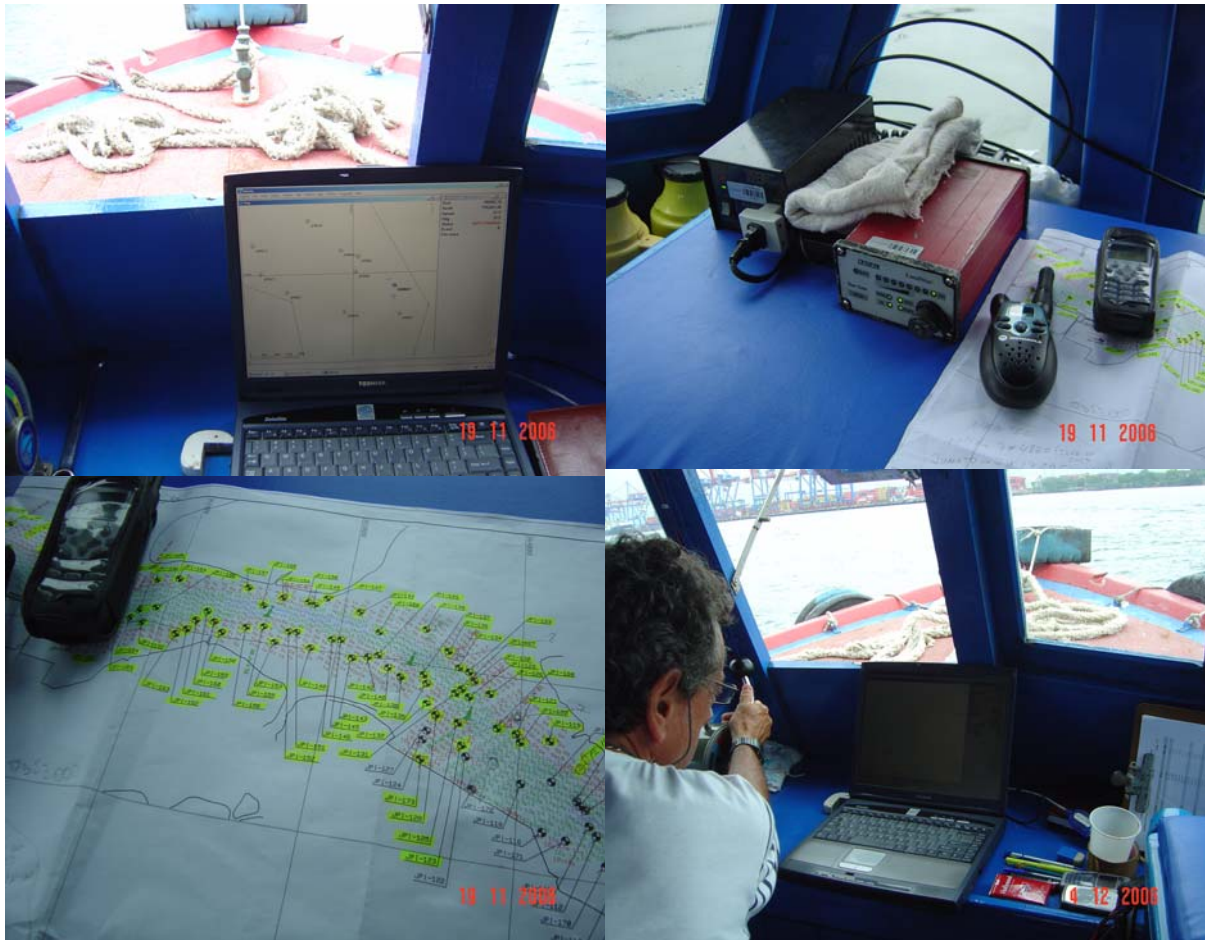
Figura 52: Aspectos da operação de posicionamento das sondagens por jet-probe e a percussão.
