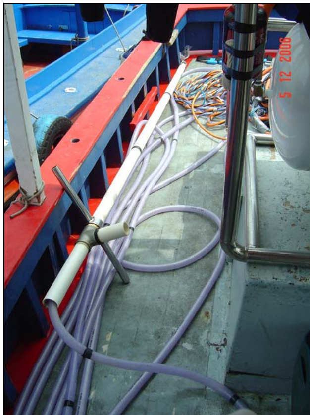
Figura 49: Detalhe de parte do equipamento de perfuração por jet-probe, usado nos serviços.
