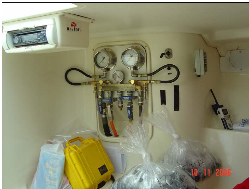
Figura 44: Sistema de controle de profundidade de precisão, acoplado a registros de fornecimento de ar aos mergulhadores. Em primeiro plano, amostras coletadas, já acondicionadas, para posterior envio ao laboratório de campo.
