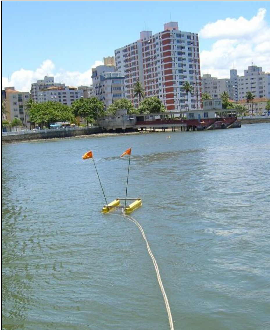
Figura 34: Fonte acústica em operação no canal de Santos.
