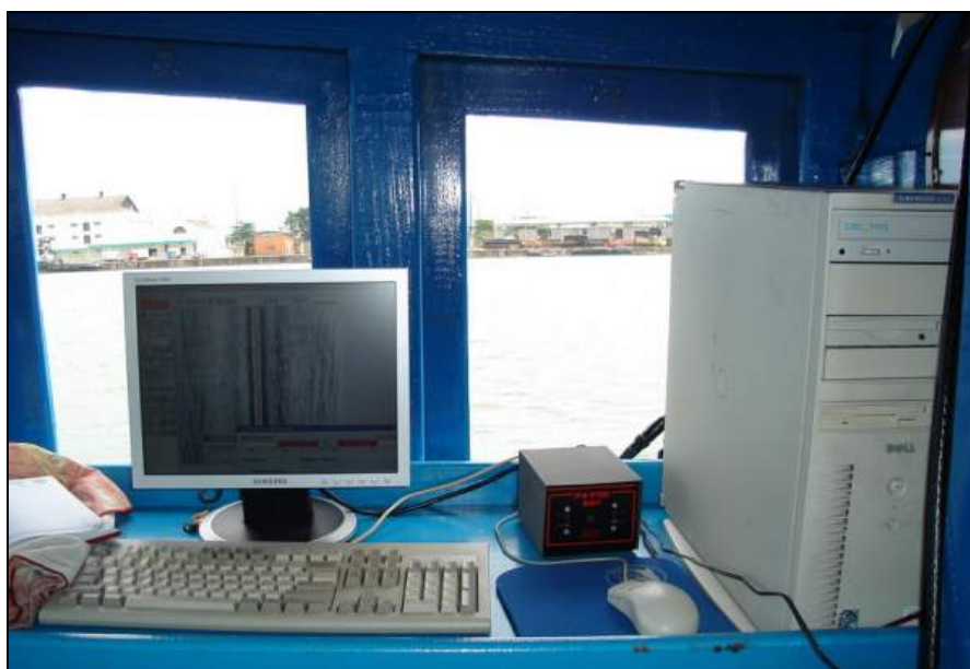
Figura 8: Sistema de aquisição de dados do sonar de varredura lateral.
