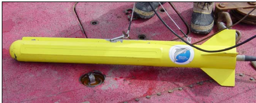
Figura 7: Fonte acústica do sonar de varredura lateral (“peixe”).
