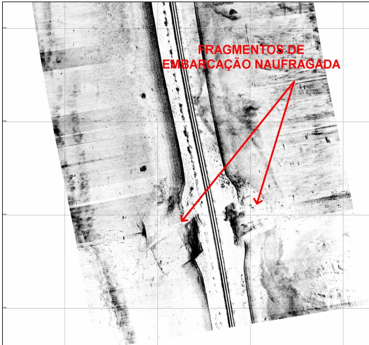
Figura 21: Registro do sonar de varredura lateral mostrando fragmentos de embarcação naufragada no canal de Santos (Navio Ais Georgis).
