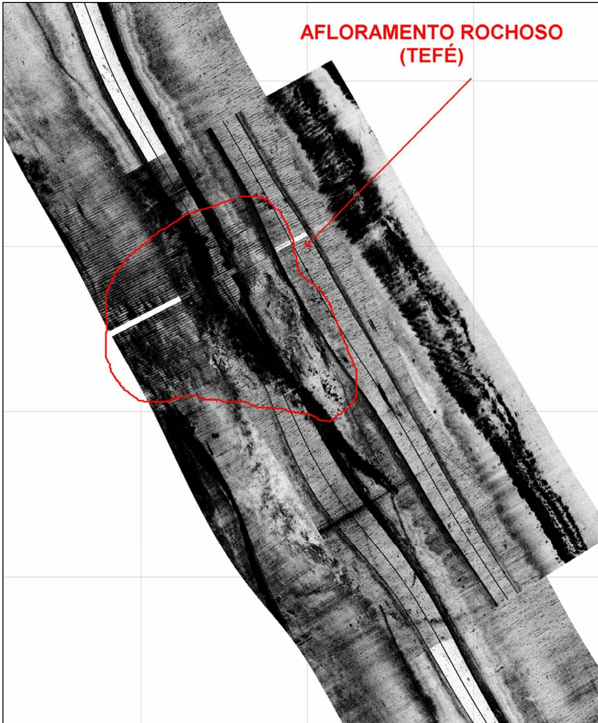
Figura 29: Sonograma obtido no canal de Santos, mostrando padrão textural de alta refletividade, característico de superfícies rochosas, no caso o afloramento denominado de Pedra de Teffé.
