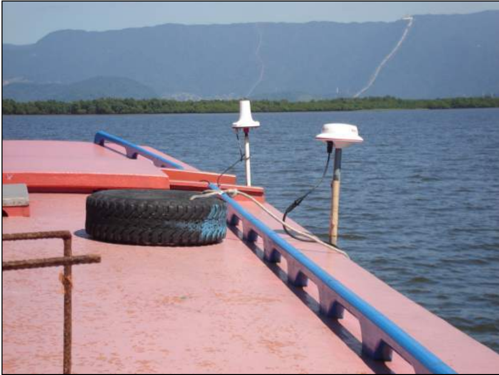
Figura 9: Detalhe das antenas de DGPS dedicadas ao sistema de sonografia.
