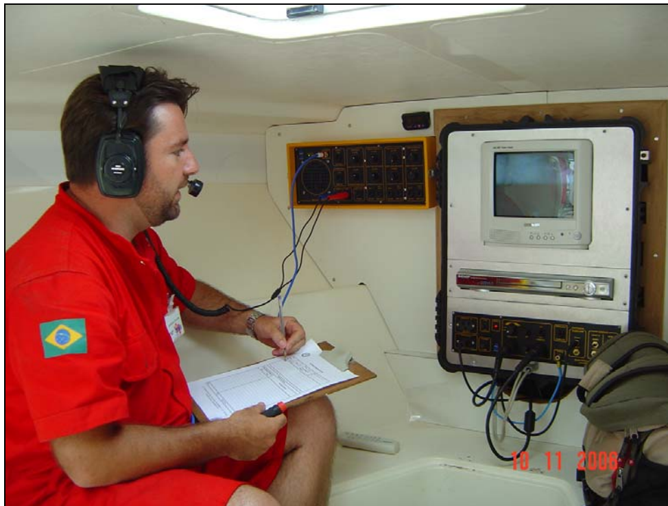
Figura 43: Monitoramento do trabalho dos mergulhadores pela equipe de bordo, através de radiofonia e circuito de TV, com gravação em DVD.
