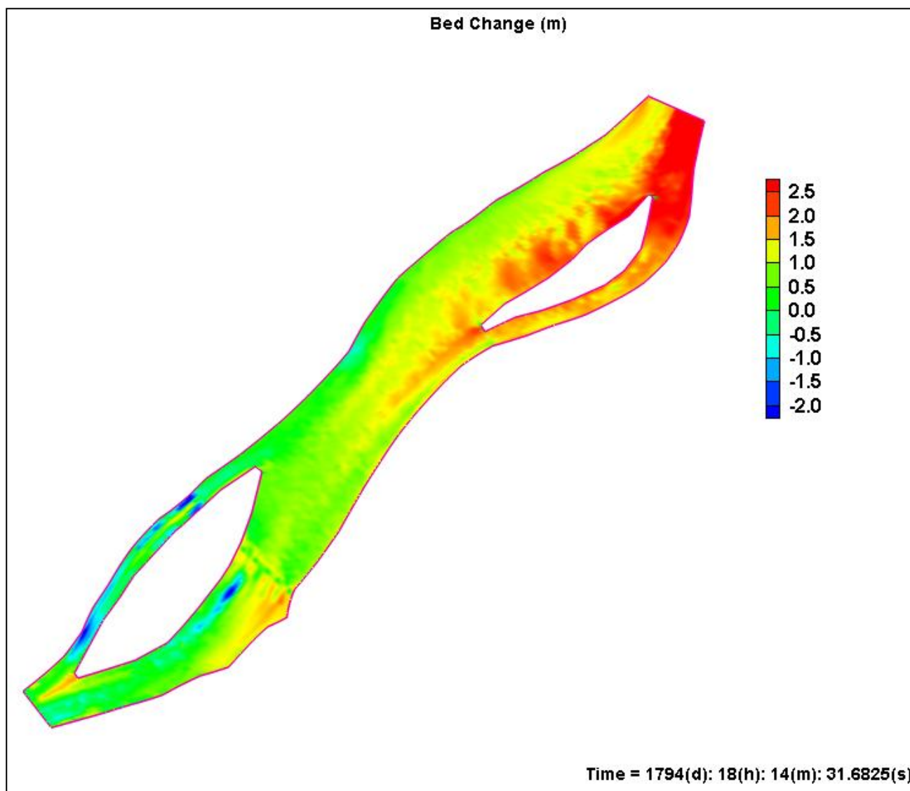
FIGURA 5.1.112 – EROSÃO/DEPOSIÇÃO (M) DO FUNDO PARA A SIMULAÇÃO 3 (NENHUMA INTERVENÇÃO): TEMPO=5 ANOS. FONTE: Os Autores (2011)
