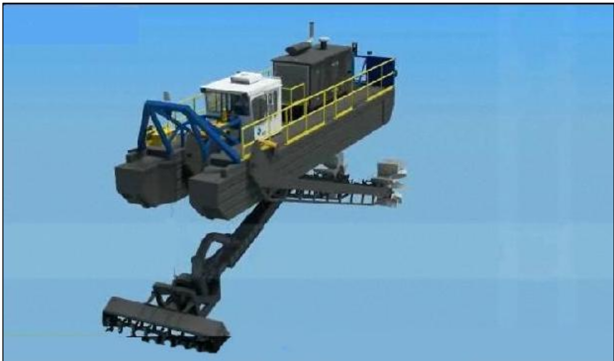
FIGURA 3.2.10 - REPRESENTAÇÃO DE DRAGA AUTO-PROPELIDA. MODELO 7012 HP DA EMPRESA AMERICANA IMS DREDGES FONTE: IMS Dredges (2010)
