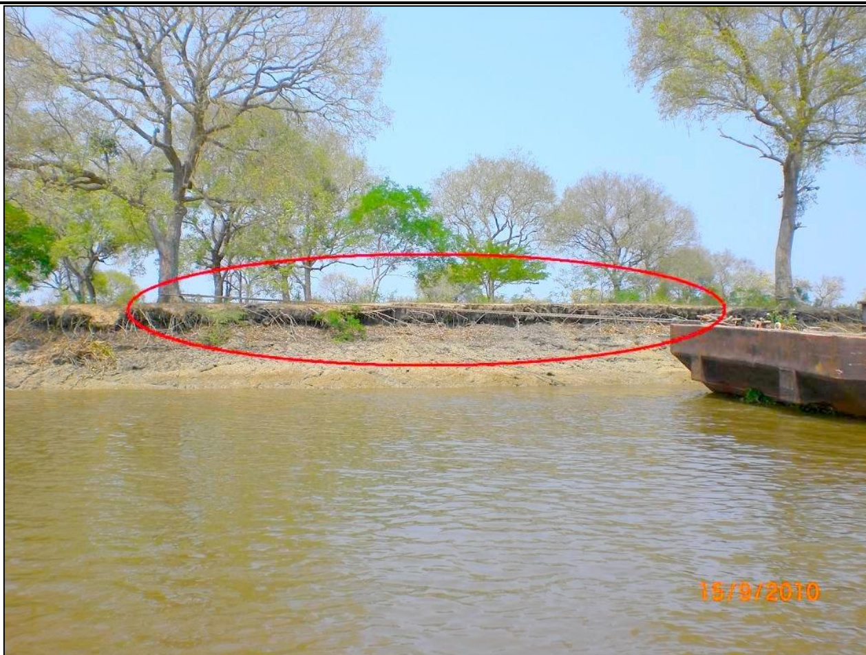
FIGURA 2.1.13 –DETALHE DE AMARRAÇÃO DA BARÇAÇA À ÁRVORE PARA DESMEMBRAMENTO DO COMBOIO FONTE: Os Autores (2010)
