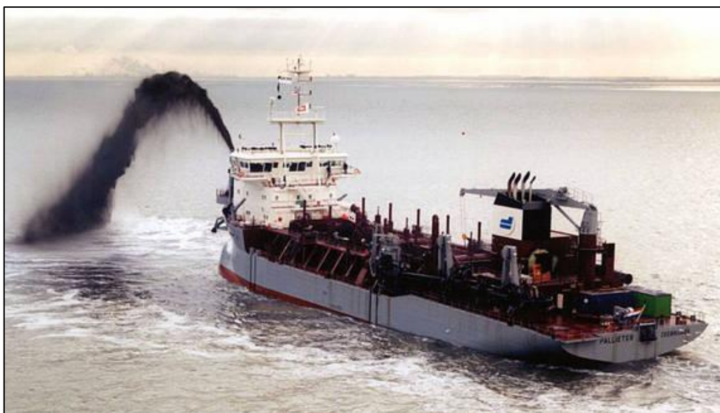
FIGURA 3.2.4 - DRAGA AUTO-TRANSPORTADORA, MODELO PALLIETER DA EMPRESA HOLANDESA IHC MERWED COM CAPACIDADE DA SISTERNA DE 5.400 M 3 FONTE: IHC Merwed (2010)
