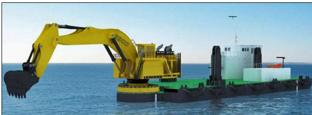
FIGURA 3.2.1 - DRAGA MECÂNICA ESCAVADEIRA FONTE: IMS Dredges (2010)
