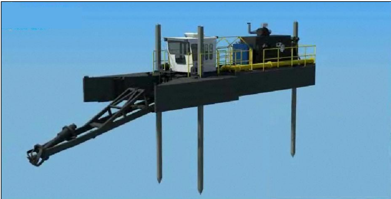
FIGURA 3.2.7 - DETALHE DE DRAGA CORTADORA COM SPUDS. MODELO: SWINGING LADDER 8010 HP DA EMPRESA AMERICANA IMS DREDGES FONTE: IMS Dredges (2010)
