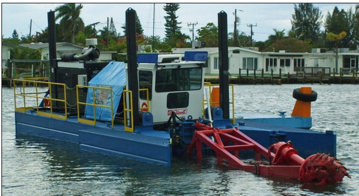
FIGURA 3.2.3 - DRAGA HIDRÁULICA DE SUÇÃO E RECALQUE COM DESAGREGADOR (CORTADOR). MODELO: SWINGING LADDER 8010 HP DA EMPRESA AMERICANA IMS DREDGES FONTE: IMS Dredges (2010)
