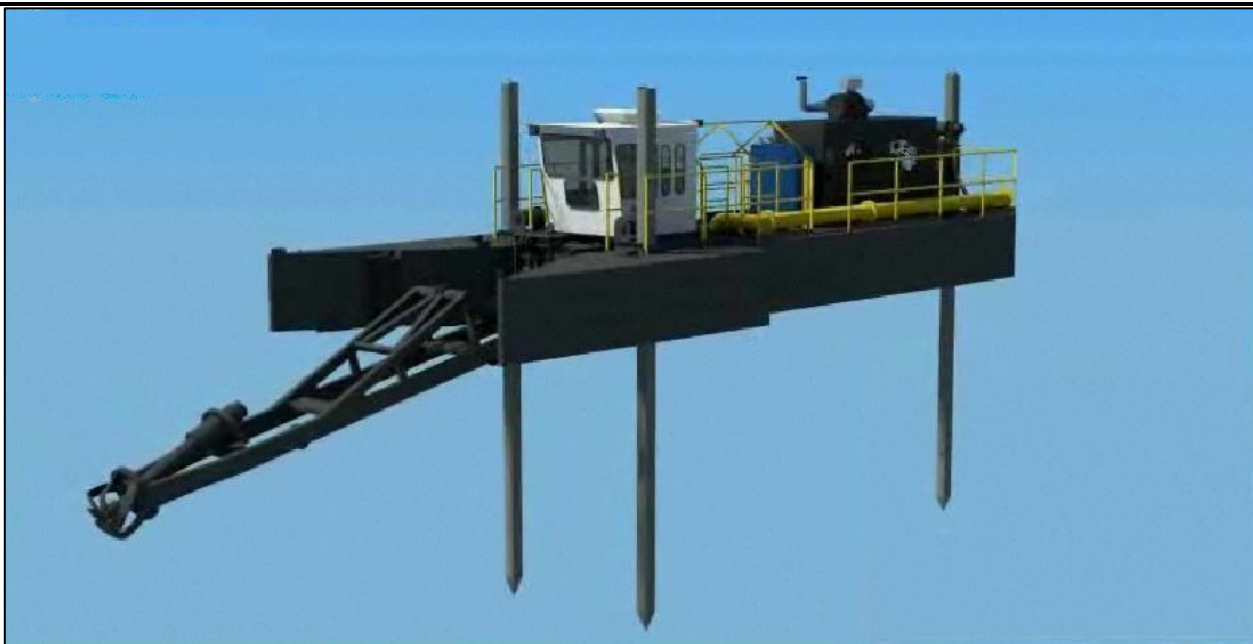
FIGURA 2.3.5 - DETALHE DE DRAGA CORTADORA COM SPUDS. MODELO: SWINGING LADDER 8010 HP DA EMPRESA AMERICANA IMS DREDGES FONTE: IMS Dredges (2010)
