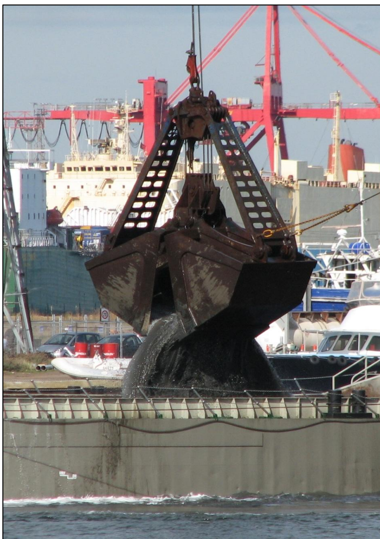
FIGURA 3.2.2 - DRAGA DE COLHER (ALCATRUZ), UM EXEMPLO DE MODELO DE DRAGA MECÂNICA, EVIDENCIANDO SUAS GRANDES DIMENSÕES E CAPACIDADE DE TRABALHO FONTE: IHC Merwed (2010)
