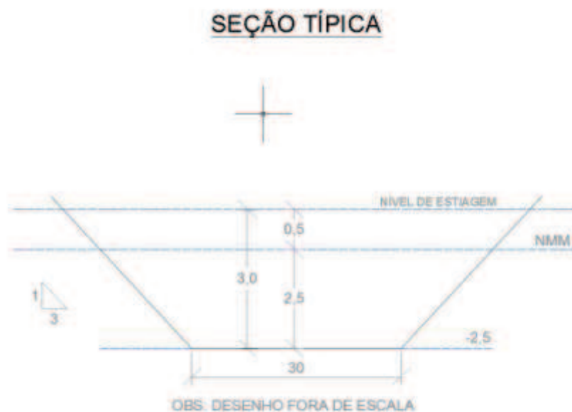
Figura 1 - Demonstração da seção a ser utilizada na dragagem
