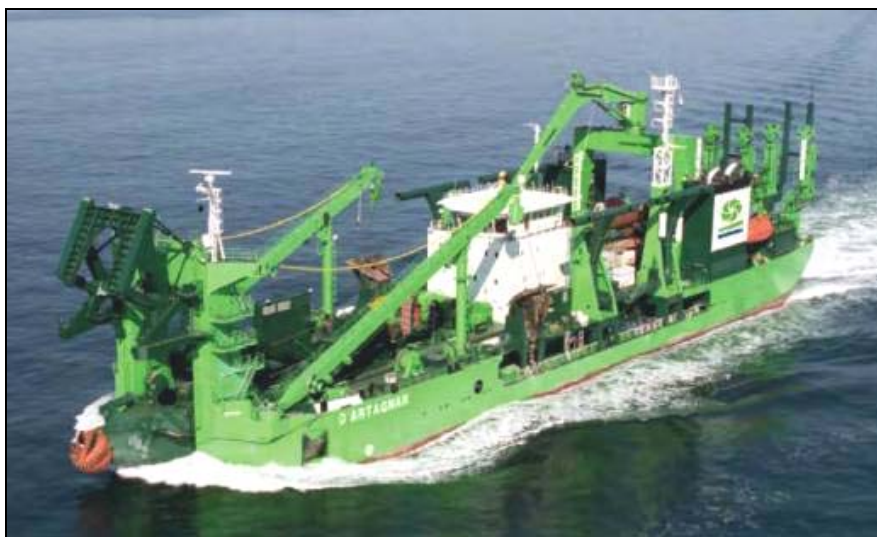
Figura 14 - Dragagem de sucção a ser utilizada. Fonte: Hidrovias Interiores – RS (2011).
