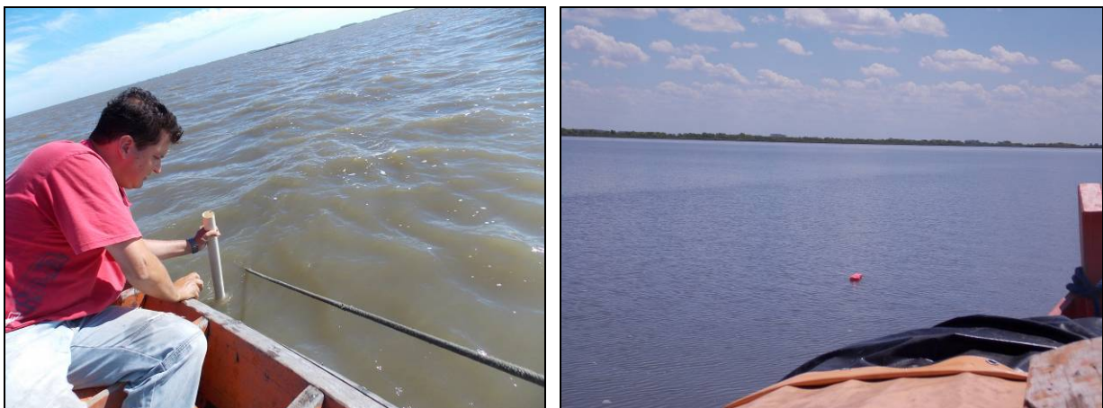
Figura 84 - Coleta de sedimento com tudo de PVC e Súber colocado no canal da Lagoa Mirim. Fonte: Autores (19/11/2012)
