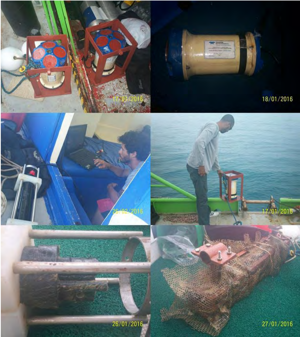
Figura 19: Equipamentos instalados nas estações. Transferência dos dados do equipamento para o computador. Sonda com incrustação de algas e proteção contra a entrada de peixes
