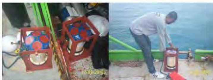
Figura 2: Equipamentos ADCP e instalação no fundeio assistida por técnico especializado.
